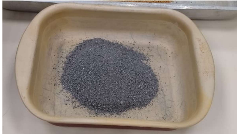
Figura 21 - Lodo têxtil após secagem em estufa, preparado para mistura.
