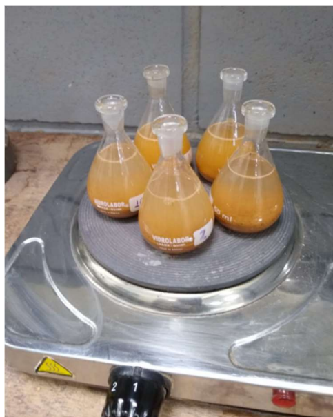
Figura 26 - Ensaio da massa específica real dos grãos.
