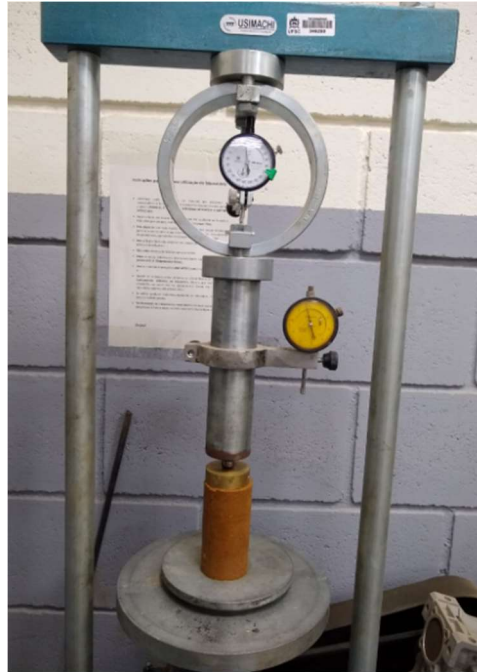
Figura 33 - Prensa utilizada para romper os corpos de prova no ensaio de compressão simples.
