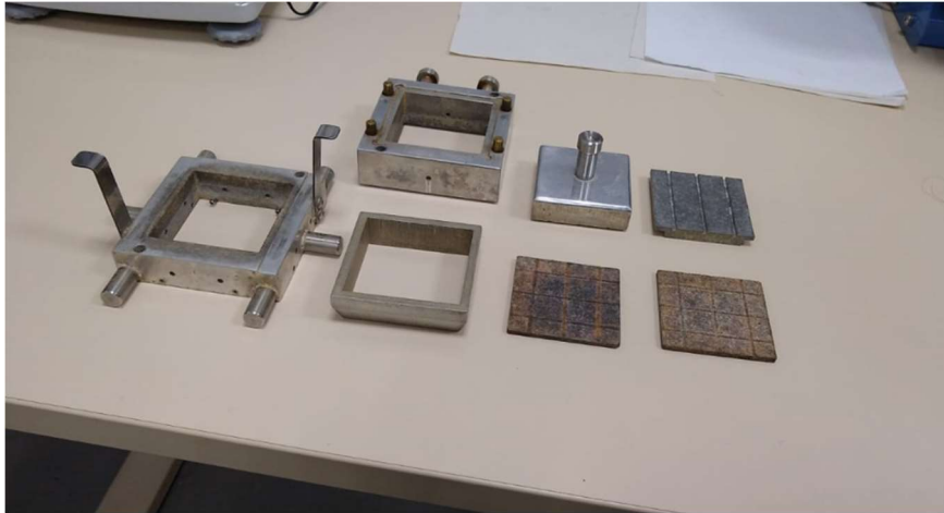
Figura 35 - Caixa de cisalhamento direto, com pedras porosas e molde metálico.
