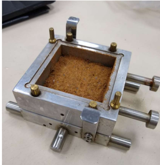
Figura 37 - Corpo de prova montado na caixa de cisalhamento.
