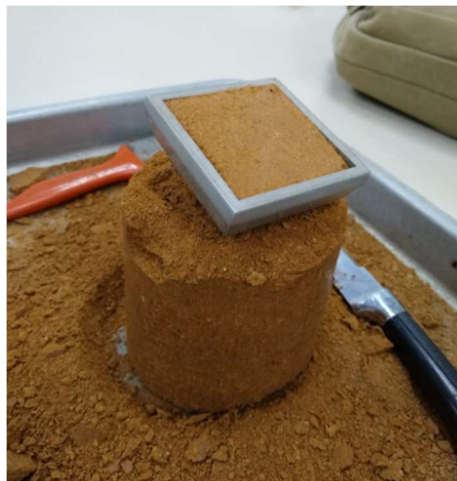
Figura 36 - Processo de moldagem dos corpos de prova para ensaio de cisalhamento direto.
