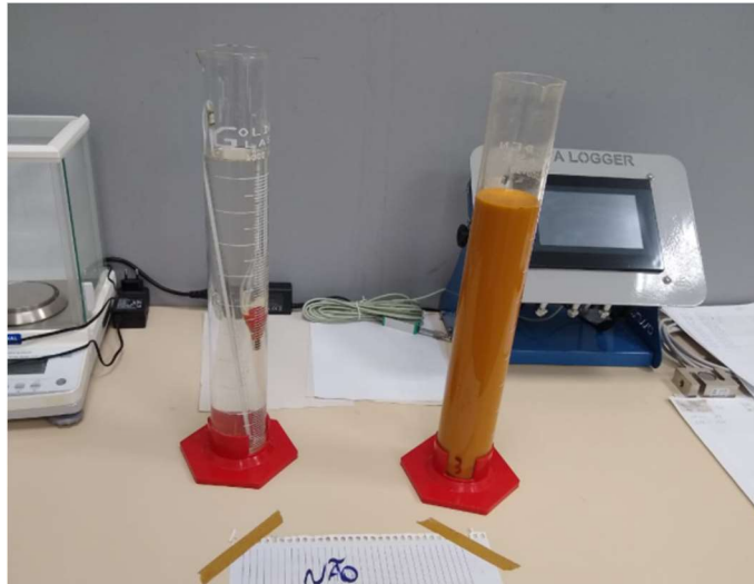
Figura 25 - Ensaio de sedimentação.
