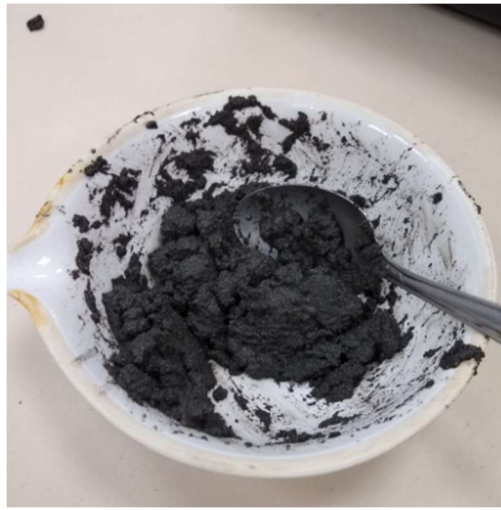
Figura 27 - Lodo têxtil com água para ensaio do limite de liquidez.
