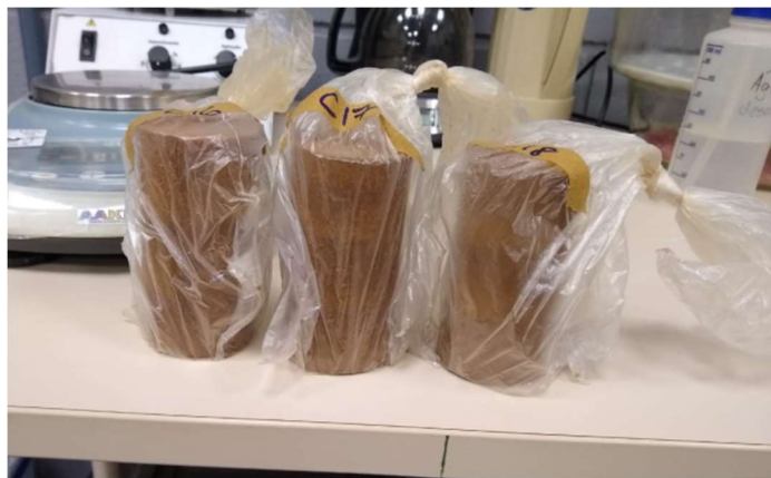
Figura 32 - Corpos de prova embaladas para o período de cura.
