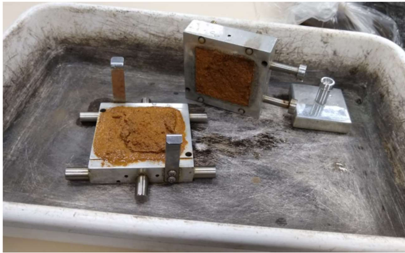
Figura 38 - Caixa de cisalhamento aberta, com o corpo prova após a realização do ensaio.
