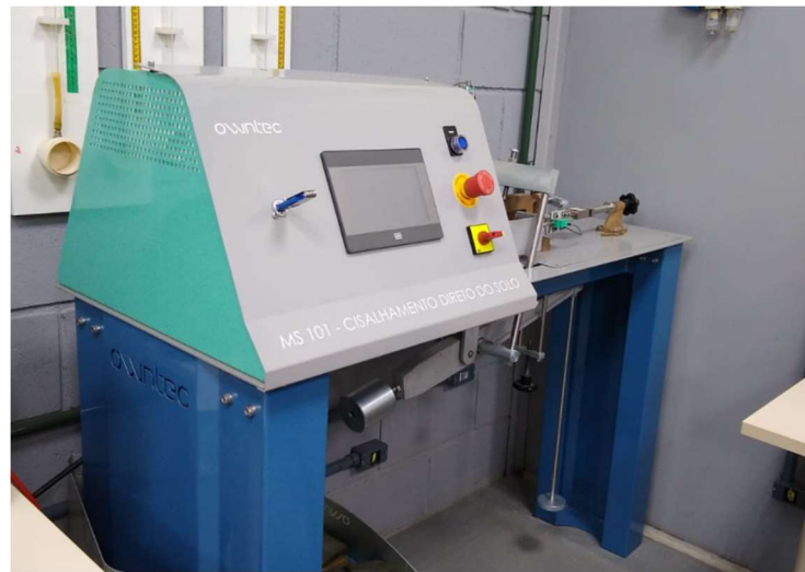
Figura 34 - Equipamento para cisalhamento direto em solos.
