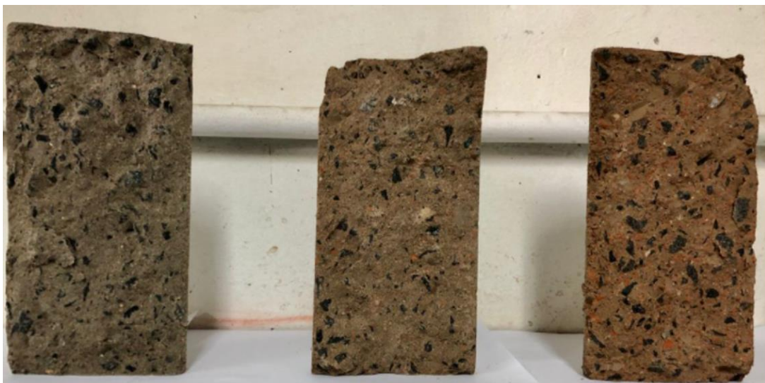
Figura 13 - Corpos de prova (T0, T1 e T2) rompidos no ensaio de tração por compressão diametral
