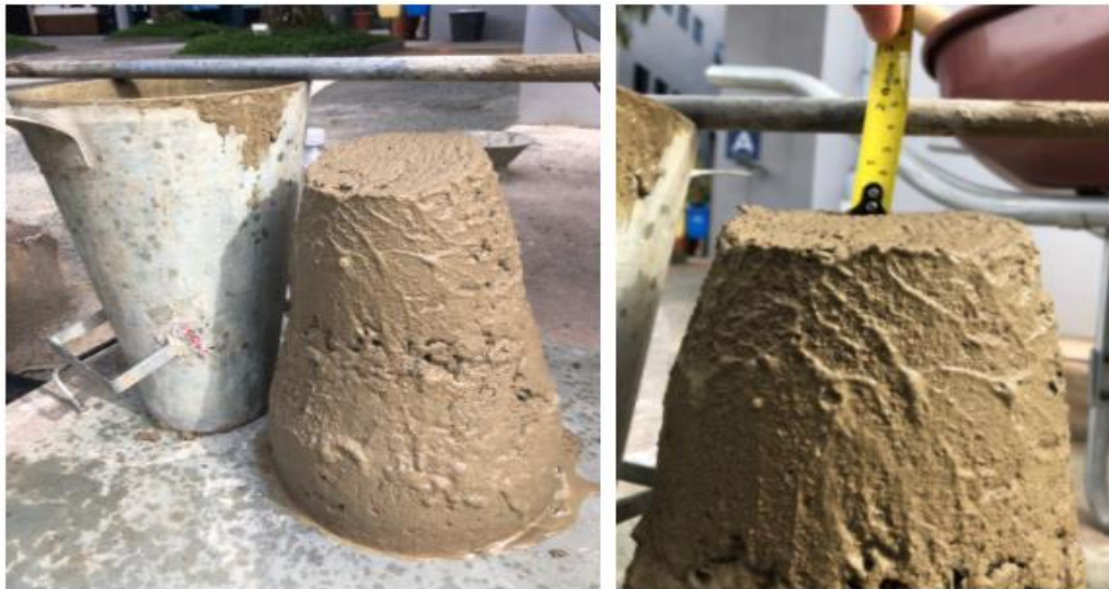
Figura 10 - Ensaio do abatimento do tronco de cone - Traço Referência (T0)
