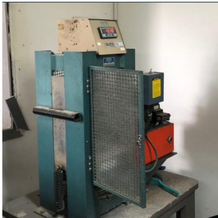
Figura 12 - Prensa hidráulica para ensaio de compressão
