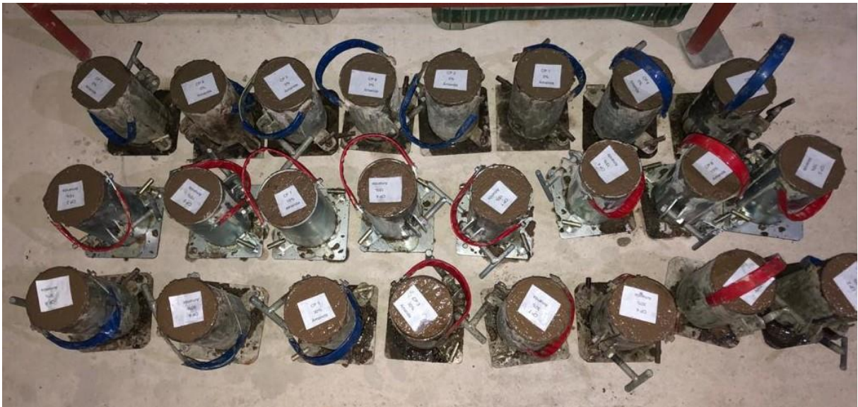
Figura 11 - Corpos de prova com resíduos de tijolos cerâmicos com teores de substituição em 0, 15 e 30%
