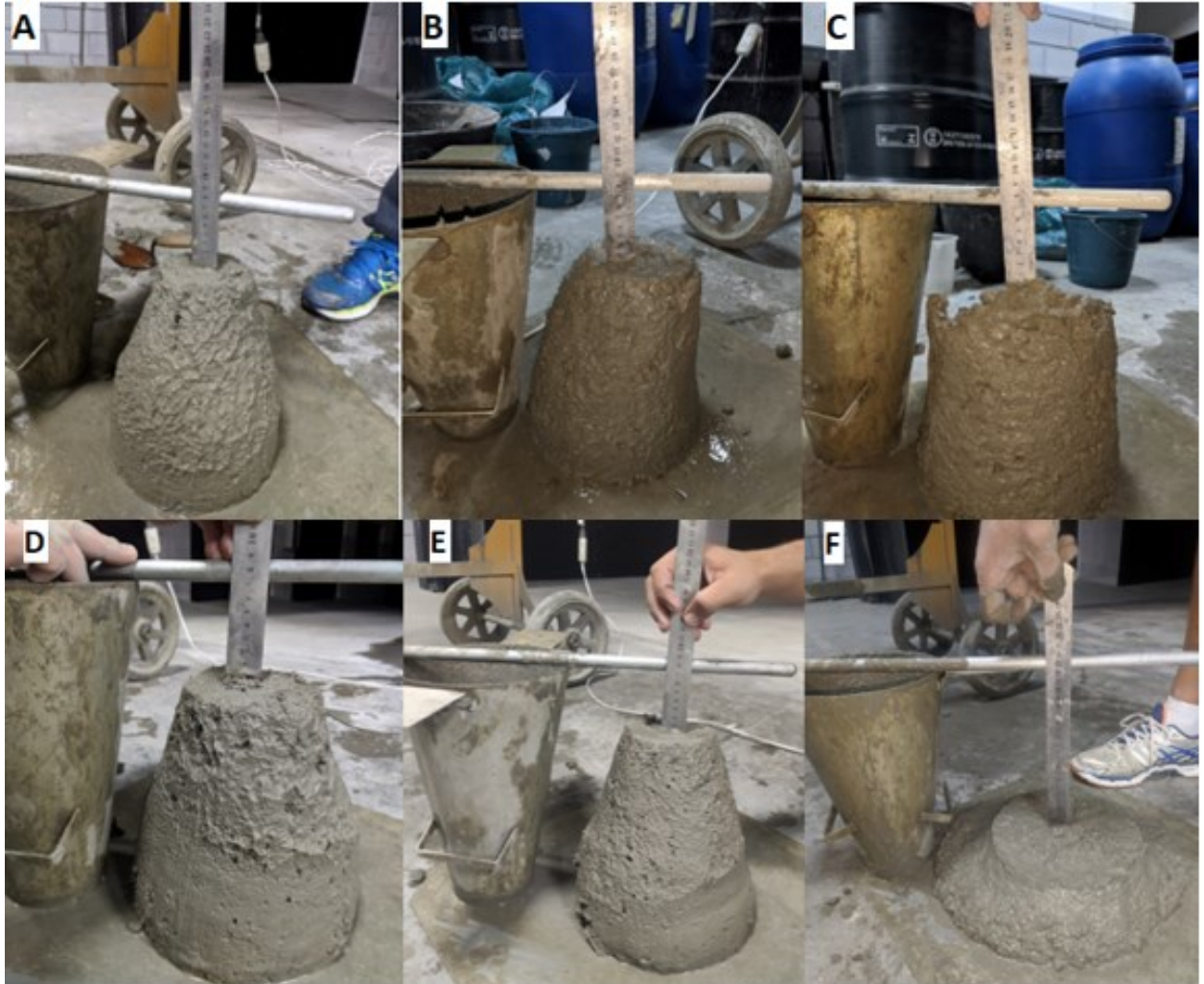
Figura 27 – Abatimento do concreto: a) Traço – TREF, b) Traço Intermediário – TI, c) Traço Rico – TR, d) Traço A, e) Traço B, f) Traço C.
