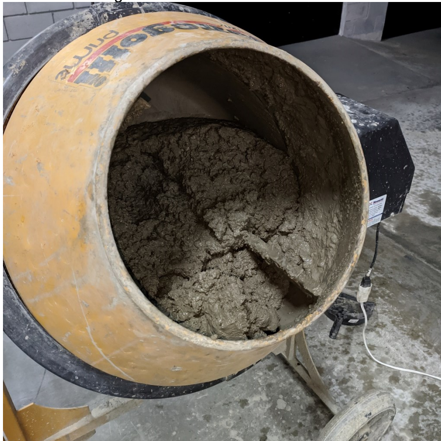
Figura 15 - Betoneira de 120 litros.
