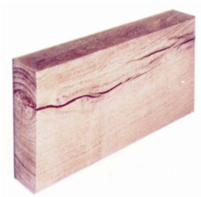
Figura 1 - Representação de uma peça de madeira com a presença de Medula
