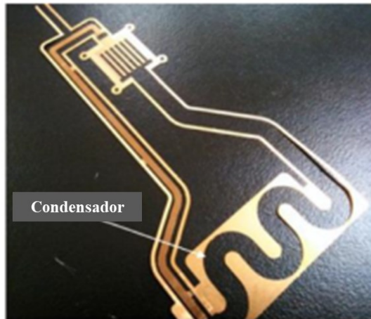
Figura 2.18: Chapa intermediária usinada por ataque químico. Fonte : Adaptado de Shioga et al. [60].
