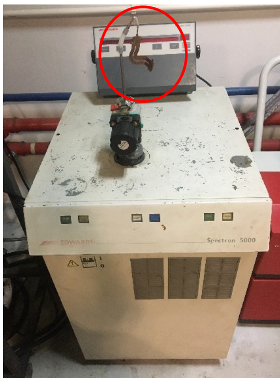
Figura 4.14: Teste de estanqueidade no detector de vazamentos da marca Edwards – Espectron 5000.
