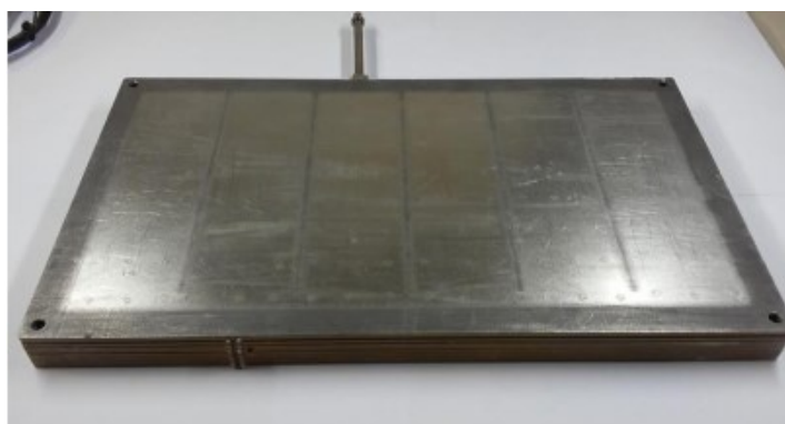
Figura 2.11: Termossifão plano após o processo de união por difusão. Fonte: Junior [30].
