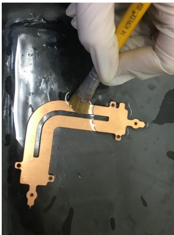
Figura 4.5: Chapa de cobre imersa em solução de ácido sulfúrico 10%.
