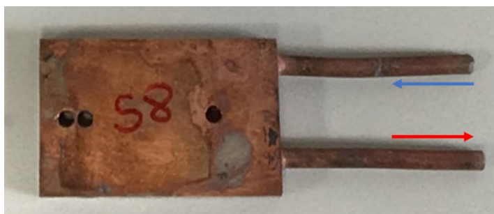
Figura 4.23: Trocador de calor para refrigeração do condensador dos tubos de calor em circuito.
