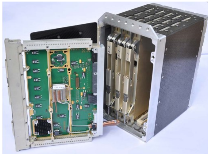
Figura 2.20: Foto do Módulo Aviônico Integrado (IMA) testado. Fonte: Zilio et al. [62].
