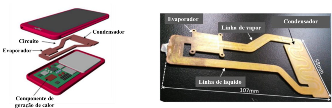
Figura 2.17: Conceito de um smartphone equipado com um tubo de calor em circuito (à esquerda) e o protótipo do tubo de calor em circuito fabricado (à direita). Fonte: Adaptado de Shioga et al. [60].
