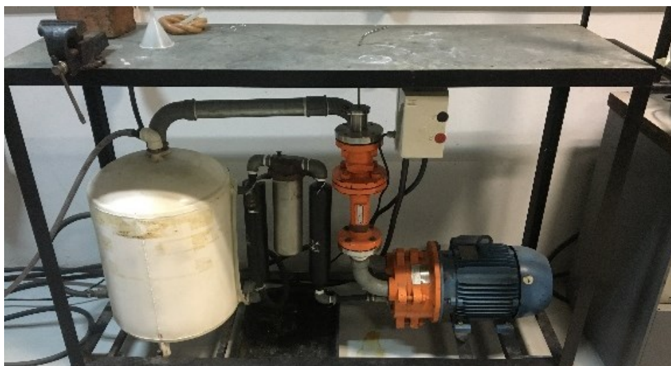
Figura 4.12: Bomba de alto vácuo de anel líquido.
