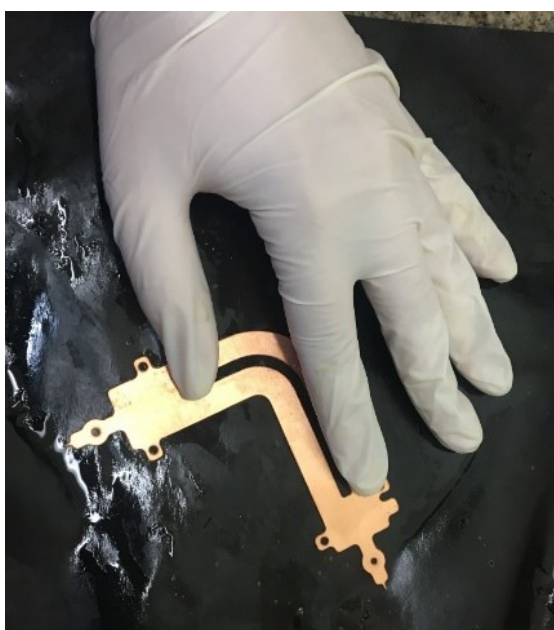
Figura 4.4: Utilização de lixa para eliminação de rebarbas na peça.
