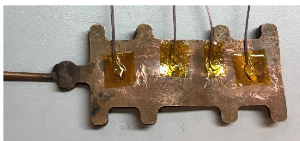
Figura 4.17: Fita Kapton nos termopares da solução térmica MTHC2.1.
