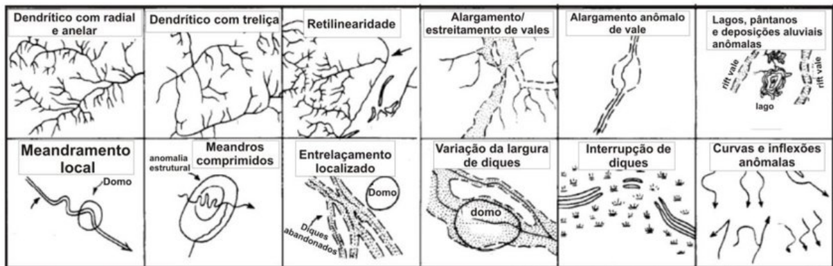
Figura 8: Anomalias de drenagem.
