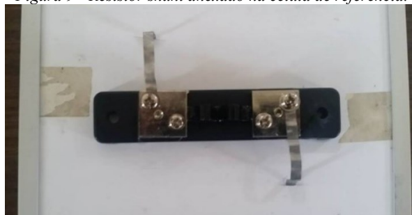
Figura 9 - Resistor shunt anexado na célula de referência.
