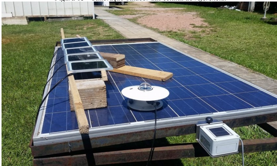
Figura 13 - Calibração outdoor das células de referência.
