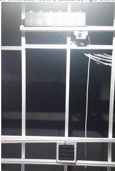
Figura 10 - Vista interna do simulador com a célula de referência na caracterização elétrica
