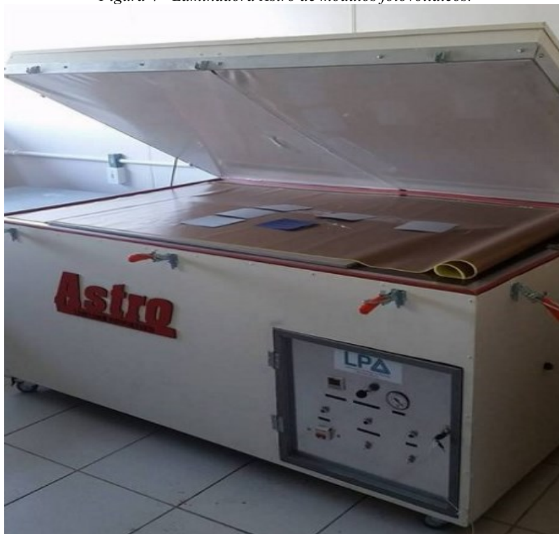
Figura 4 - Laminadora Astro de módulos fotovoltaicos.
