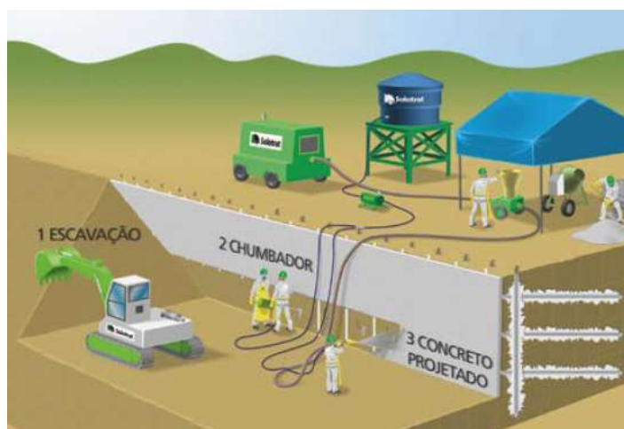
Figura 8 - Fases construtivas em corte
