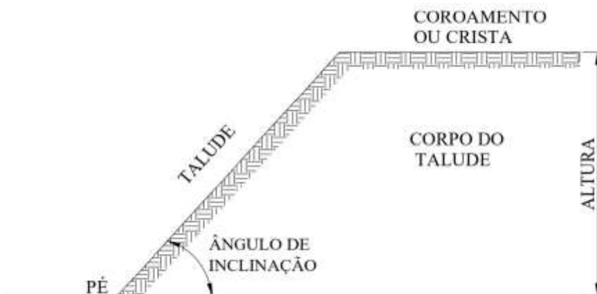
Figura 1 - Terminologias do talude
