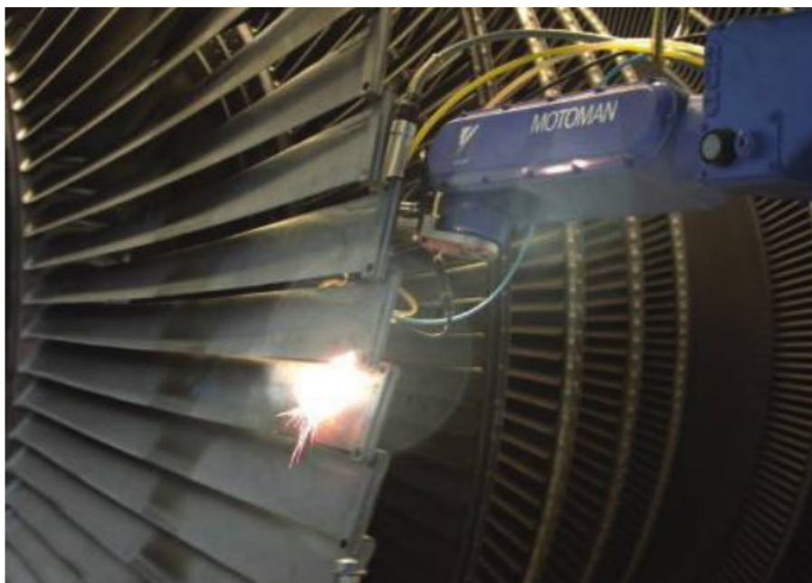
Figura 10: Reparo em campo de turbina de gás.
