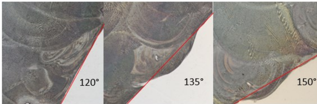
Figura 24: Área fundida na superfície lateral do reparo.
