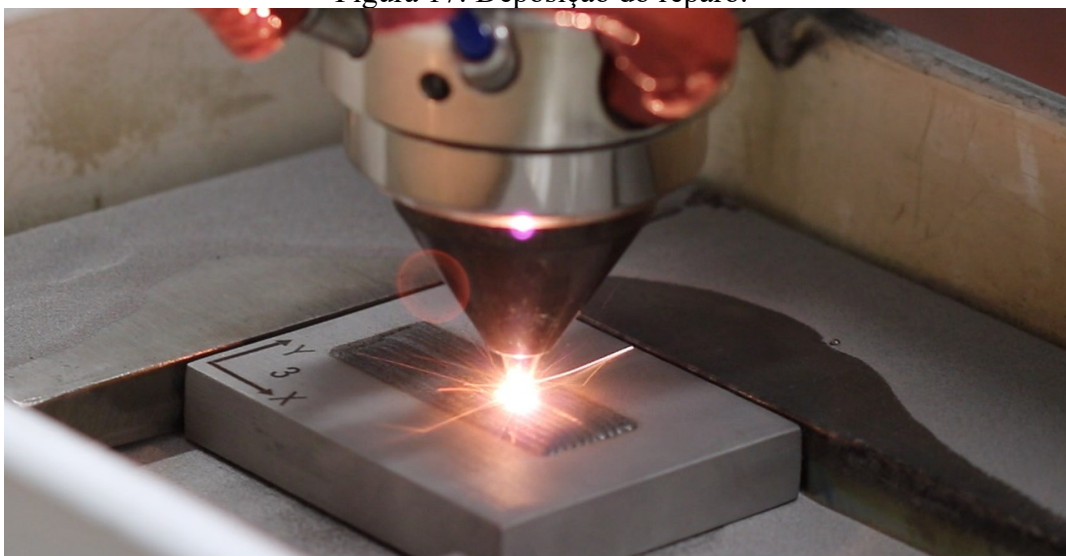
Figura 17: Deposição do reparo.
