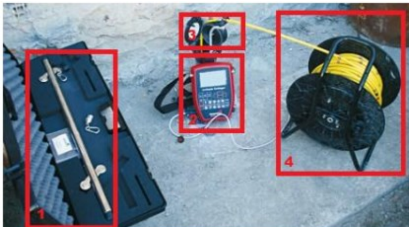
Figura 13 - Equipamentos de instrumentação de um inclinômetro
