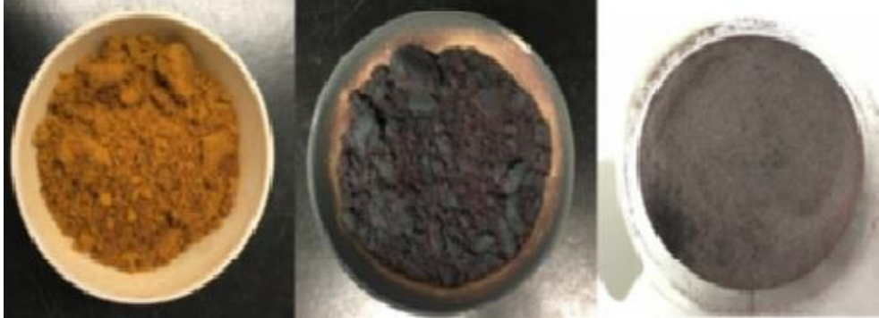
Figura 4- Amostras de AreiaFe 1/100 após aquecimento, calcinação e lavagem, respectivamente.
