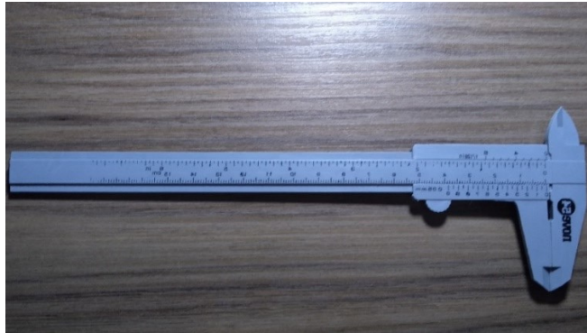
Figura 9 - Paquímetro utilizado para medições de parâmetros dimensionais.
