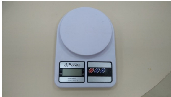
Figura 10 - Balança digital utilizada para medir a massa dos veículos.
