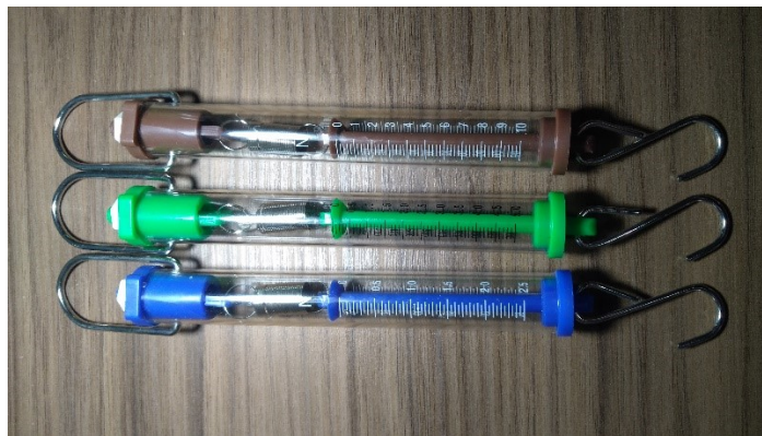
Figura 13 - Conjunto de dinamômetros utilizados para aferir o esforço de tração da locomotiva.
