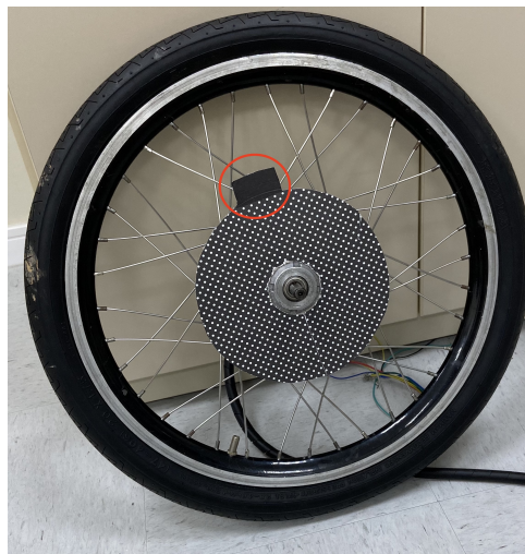
Figura 21 – Motor com disco acoplado para medição da velocidade.
