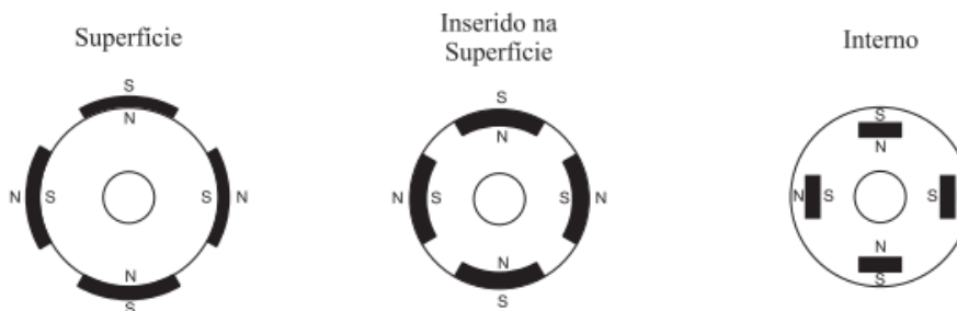
Figura 11 – Possíveis arranjos dos ímãs no rotor do BLDC.
