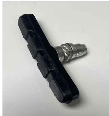
Figura 26 – Sapata de freio utilizada como elemento de atrito.
