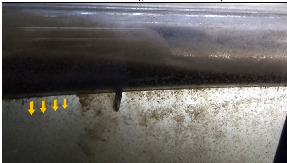
Figura 82 – Imagem aproximada de um duto circular, para mostrar o comportamento típico dos flocos ao saírem através da abertura longitudinal inferior nas Etapas 1 e 2.
