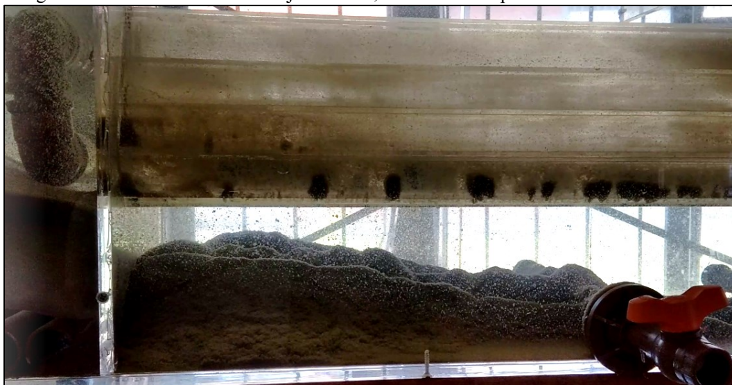
Figura 112 – Vista lateral do arranjo de dutos, com acúmulos pontuais no fundo dos dutos.
