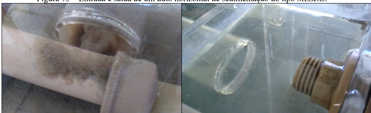
Figura 93 – Entrada e saída de um duto horizontal de sedimentação do tipo MLSens .
