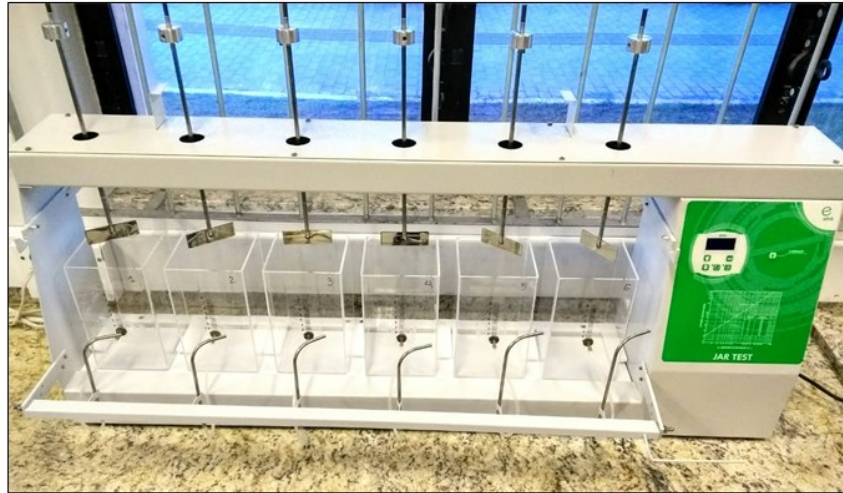
Figura 33 – Equipamento Jarrest (com reatores em descontinuo) utilizado nesta pesquisa.
