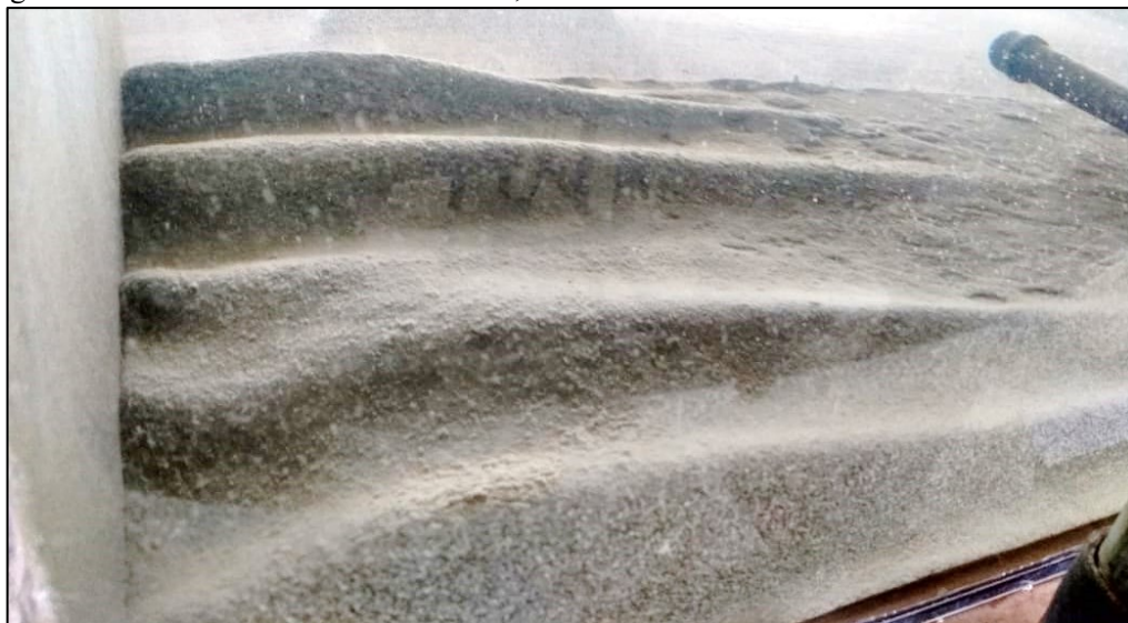
Figura 94 – Zona de lodo do Decantador 1, salientando o monte formado abaixo de cada duto.
