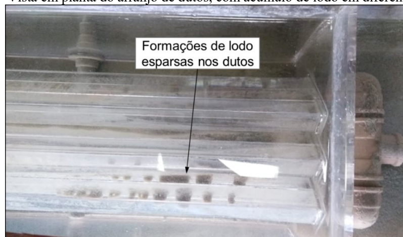
Figura 111 – Vista em planta do arranjo de dutos, com acúmulo de lodo em diferentes intervalos.
