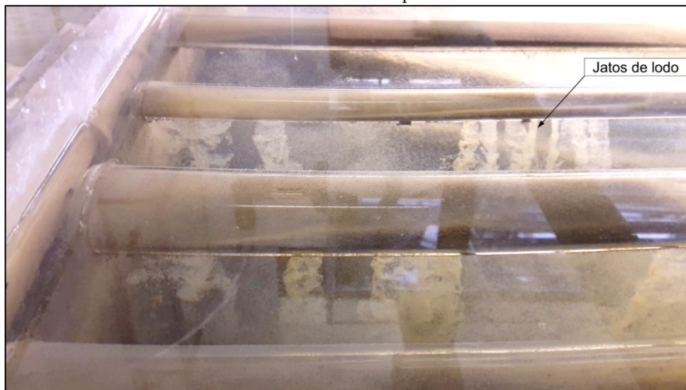
Figura 83 – Comportamento típico dos flocos ao saírem através da abertura longitudinal inferior dos dutos horizontais na Etapa 3.
