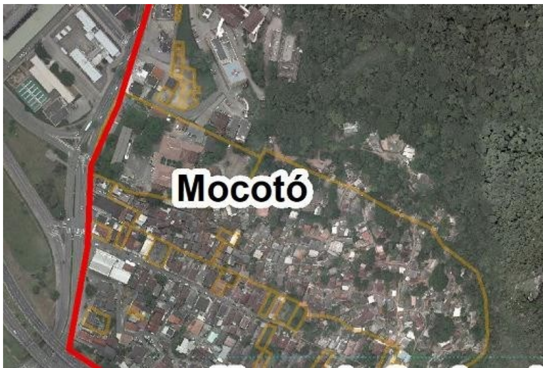
Figura 36: Rede de Esgoto na comunidade do Mocotó.
