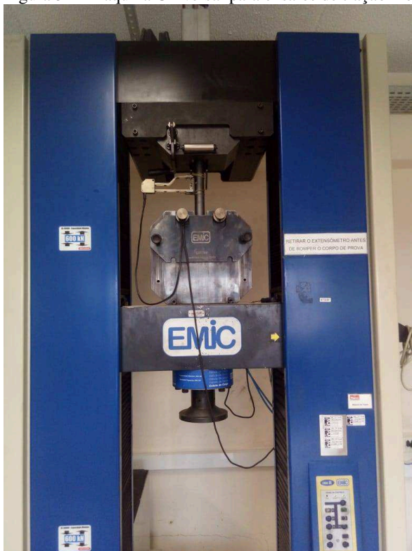
Figura 31 - Máquina Universal para ensaios de tração modelo EMIC de 600kN.
