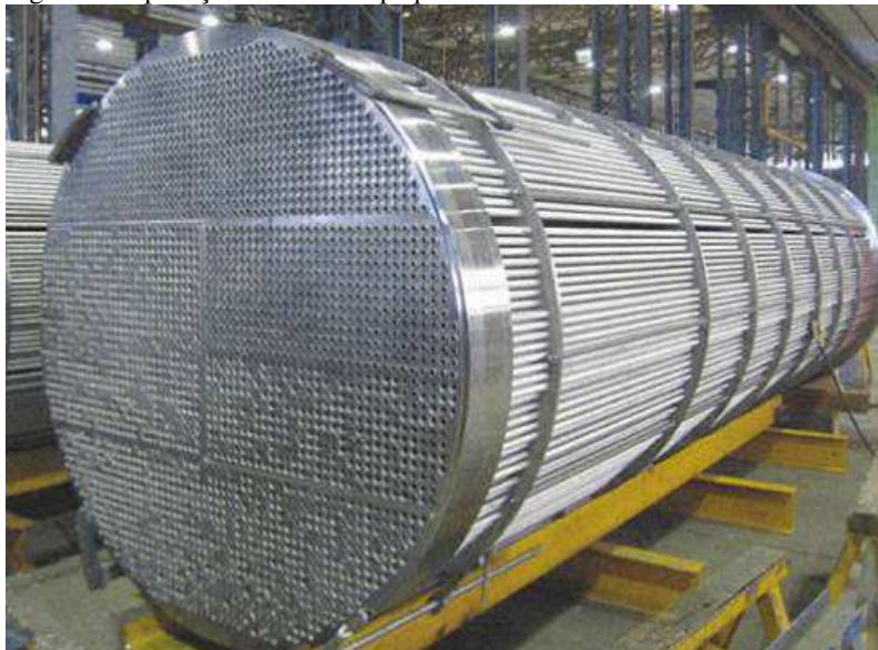
Figura 9 - Aplicação de tubos de pequeno diâmetro em caldeiras.
