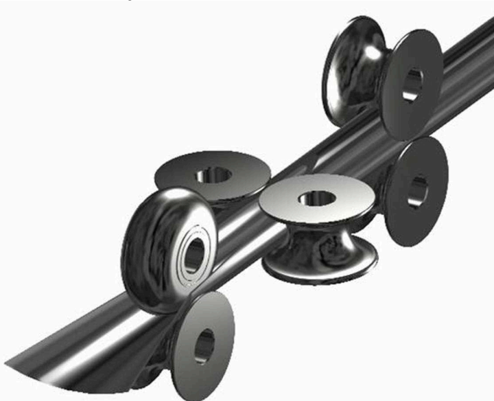
Figura 3 - Rolos de formação do tubo.
