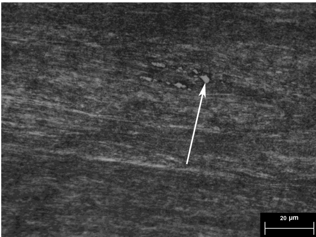
Figura 5.28: Micrografia da condição F50%50% após 0,5 h de envelhecimento a 600 °C. A seta branca indica a austenita reversa.
