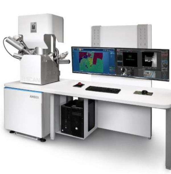
Figura 16 Equipamento utilizado para obtenção das imagens de MEV e preparação das lamelas para transmissão. Imagem fornecida pelo empresa TESCAN.
