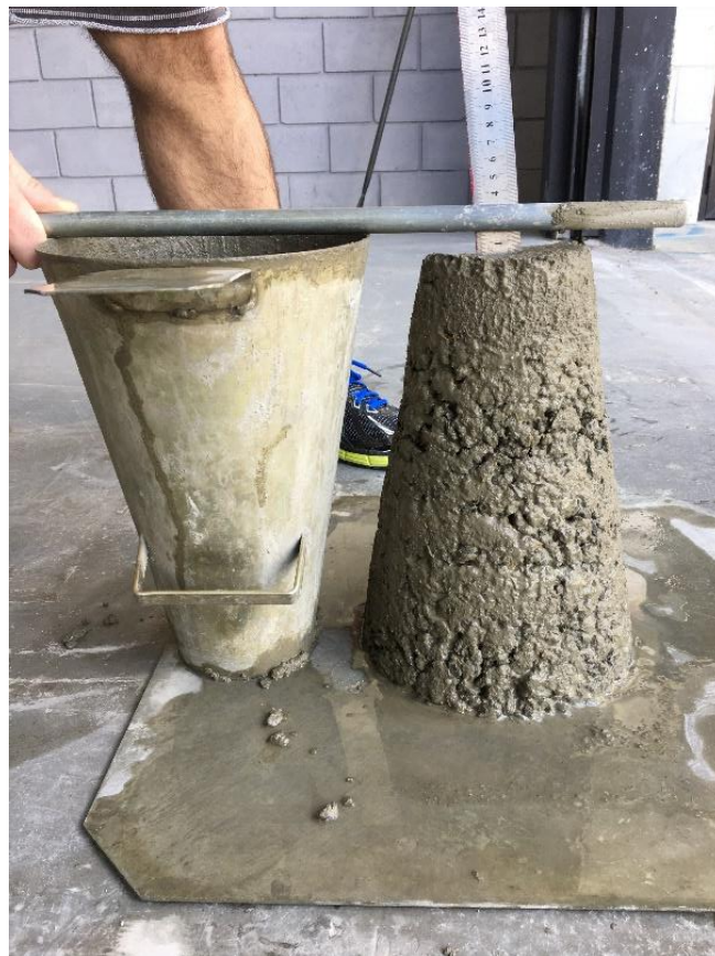
Figura 5 - Diferença entre a altura do molde e o concreto abatido.
