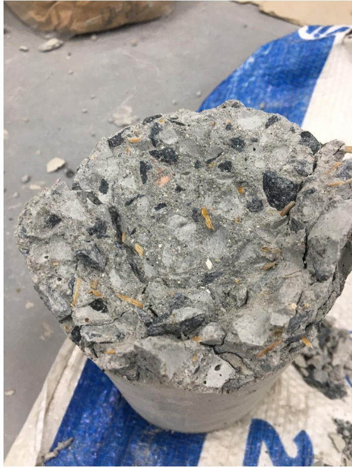
Figura 6 - Corpo-de-prova com substituição parcial de CA rompido.
