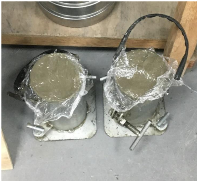
Figura 4 - Corpos de prova moldados após processo de concretagem.
