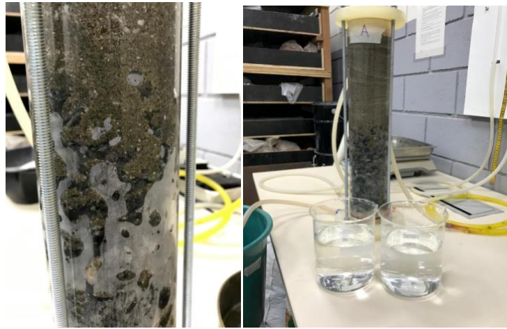
Figura 34: Transporte de areia para a camada de brita nas estruturas A e C.
