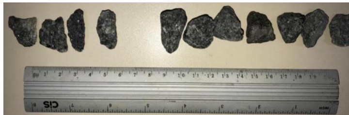
Figura 19: Grãos lamelares e volumosos da brita 1.
