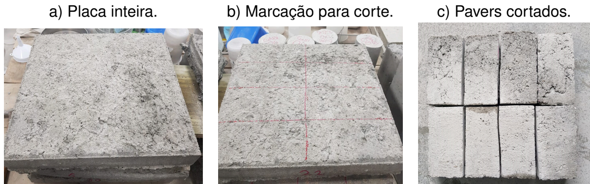
Figura 19 – Processo de corte das placas de concreto para produção de pavers.
