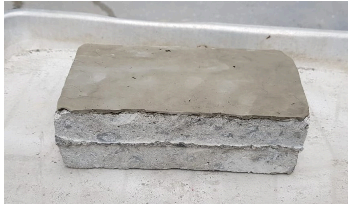
Figura 20 – Paver após capeamento.
