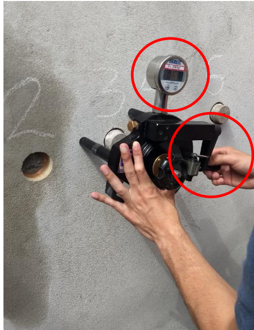
Figura 29 – Movimentos manuais no equipamento para identificação da carga de ruptura
