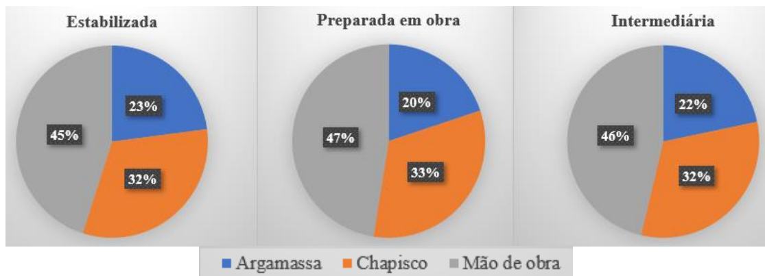
Figura 57 – Porcentagem do custo de material e mão de obra em revestimentos com chapisco
