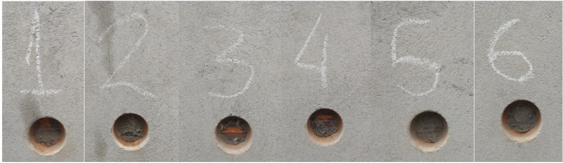
Figura 38 – Ruptura identificada nos corpos de prova da AECCP
