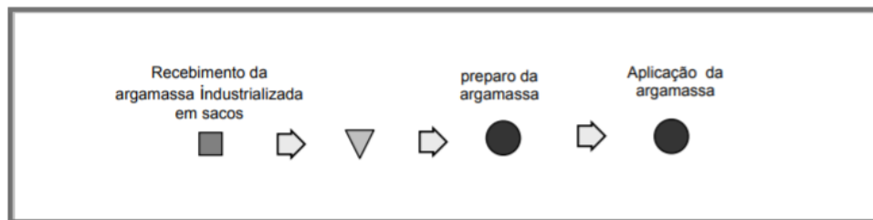
Figura 8 – Fluxograma dos processos para produção da argamassa industrializada
