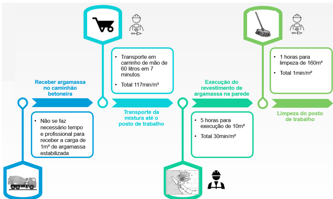
Figura 52 – Esquema da linha de produção da argamassa estabilizada
