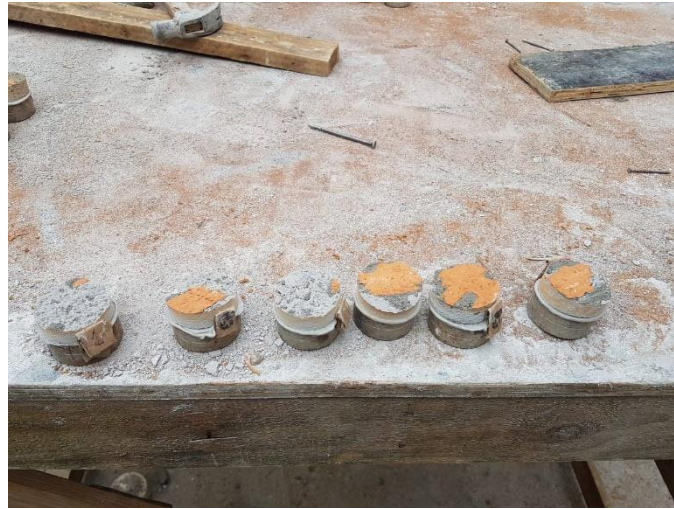
Figura 32 – Ruptura identificada nos corpos de prova após realização do ensaio
