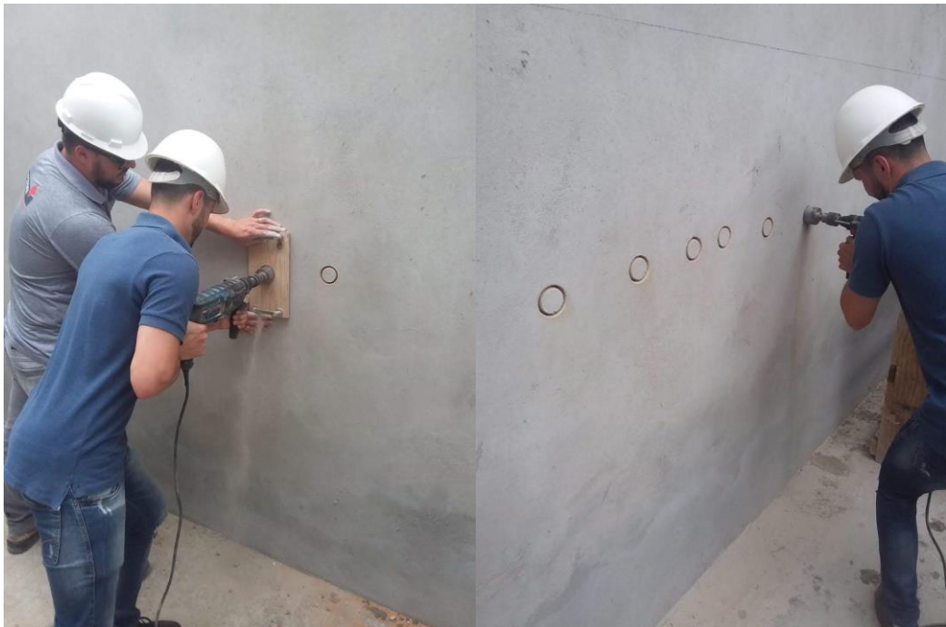
Figura 25 – Corte dos corpos de prova com uso de furadeira, serra-copo e gabarito
