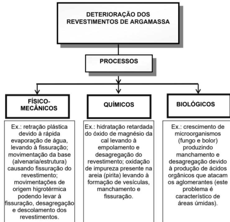
Figura 17 – Processos de deterioração dos revestimentos de argamassa
