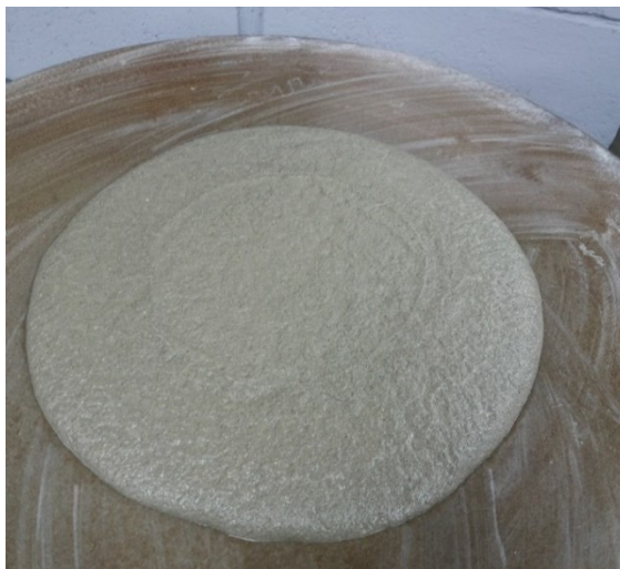
Figura 14 – Espalhamento da argamassa com 2% de adição de lodo
