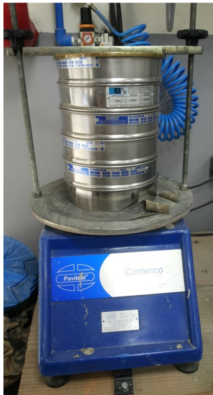
Figura 3 - Vibrador mecânico e conjunto de peneiras usados no ensaio de granulometria
