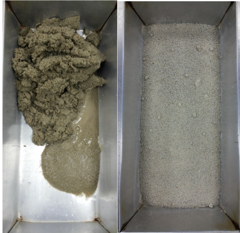
Figura 5 – Lodo têxtil (Saturado e Seco)
