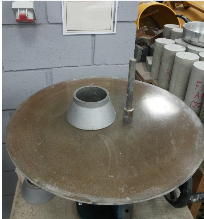
Figura 6 - Equipamentos para ensaio de Índice de Consistência
