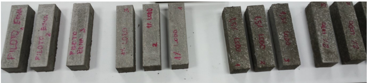
Figura 9 - Corpos de prova identificados e desmoldados
