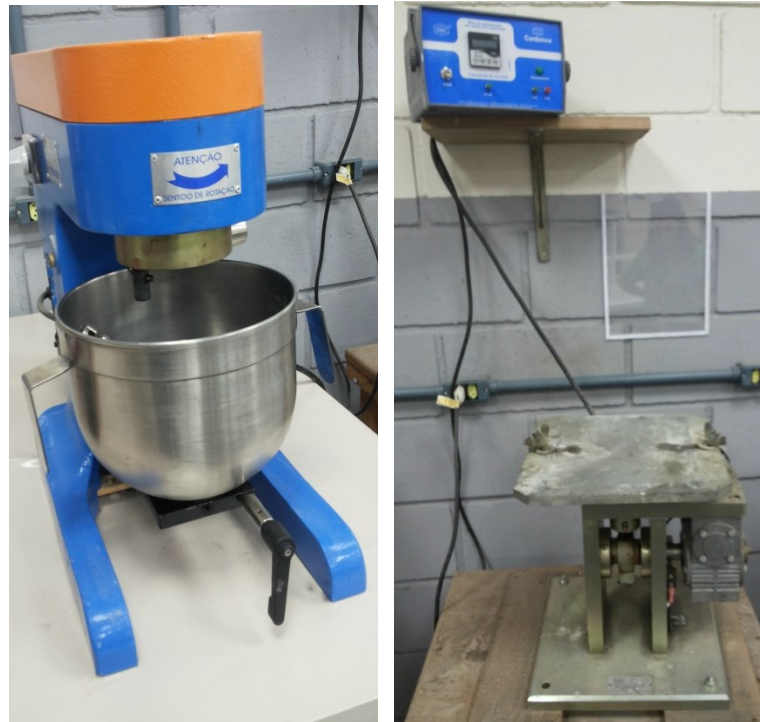
Figura 7 - Equipamentos para mistura e moldagem da argamassa
