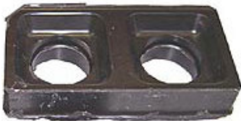
Fig.4 a- Molde para fabricação de bloco vazado canaleta
