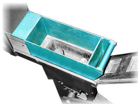
Fig.5a - Gaveta para prensagem dos blocos
