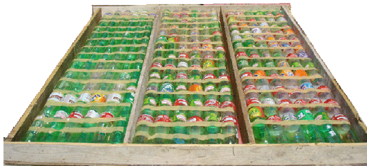
Formas para painéis de garrafas plásticas.
