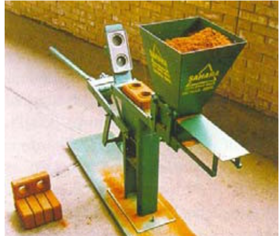
Fig.3 a - Prensa manual para um bloco Permaq. b Prensa com alavanca para pressão Sahara.
