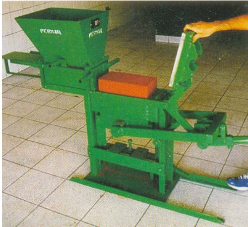
Fig.3 a - Prensa manual para um bloco Permaq. b Prensa com alavanca para pressão Sahara.
