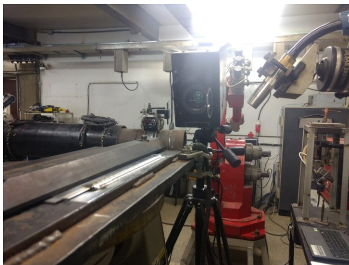
Figura 66 - Localização da câmera termográfica em relação a bancada de ensaios.
