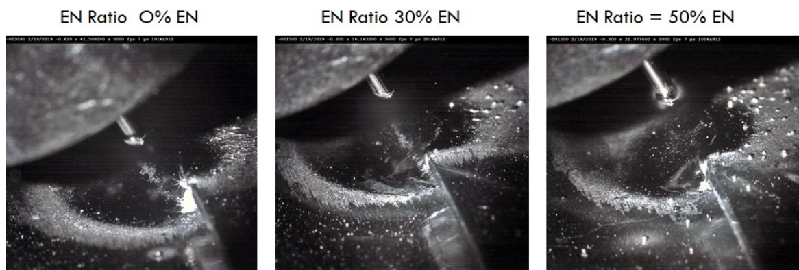
Figura 89 - Imagens das filmagens de alta velocidade (Pulsado CA/OTC DW-300, gap = 1,5\text{ mm} ).
