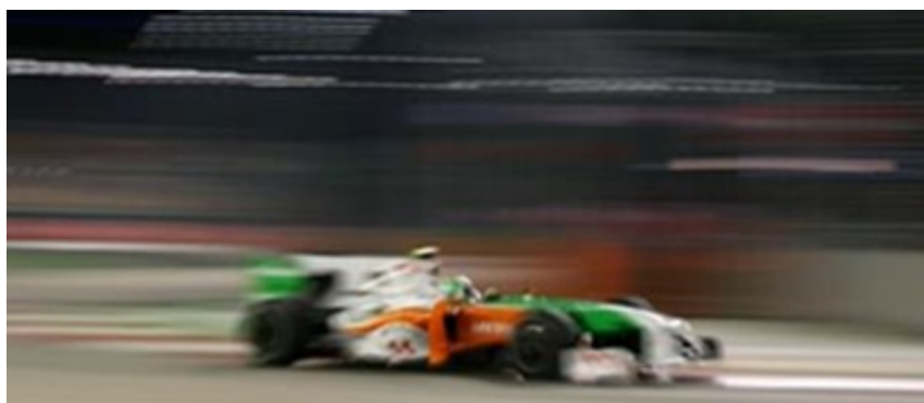
Figura 20 - Imagem de um F1 intencionalmente fotografado com tempo de exposição alto (1/60 segundos \cong 16,7 ms).
