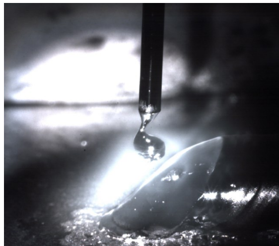
Figura 69 - Imagem capturada com câmera de alta velocidade durante soldagem sobre chapa.
