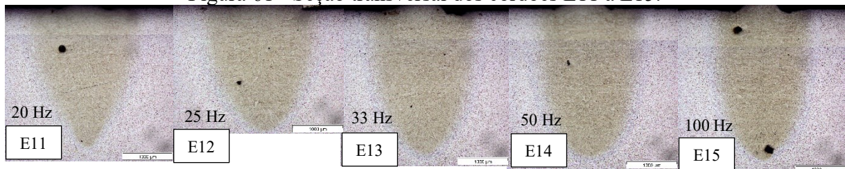
Figura 61 - Seção transversal dos cordões E11 a E15.
