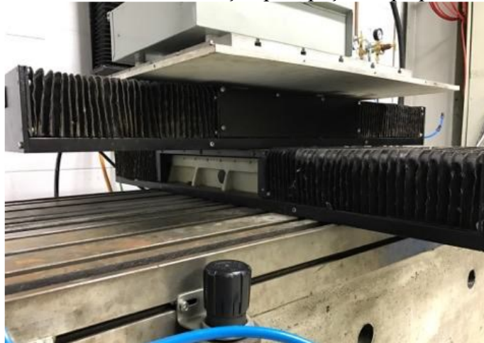
Figura 41 - Sistema de movimentação para peças de pequenas dimensões.
