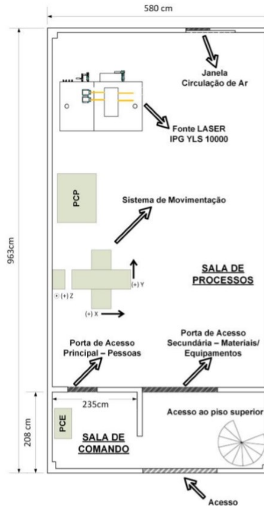
Figura 42 – Vista superior do ambiente projetado para prover segurança a durante processamentos a laser no laboratório LMP/Laser.
