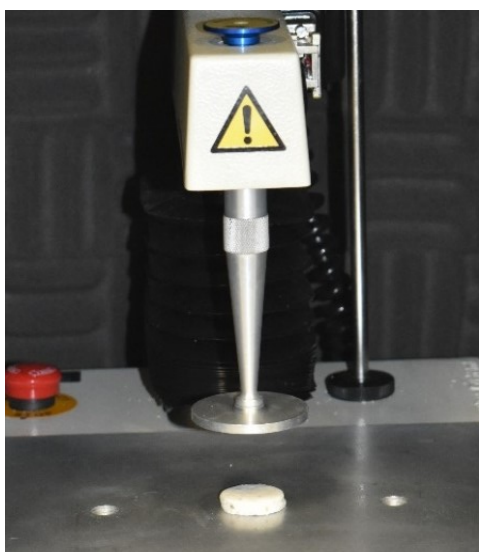
Figura 10 - Ilustração dos ensaios de TPA nas massas dos snacks com Kappaphycus alvarezii
