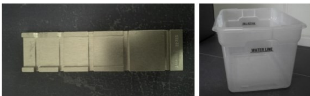
Figura 5 – Haste metálica e recipiente com água utilizados para calibração semanal
