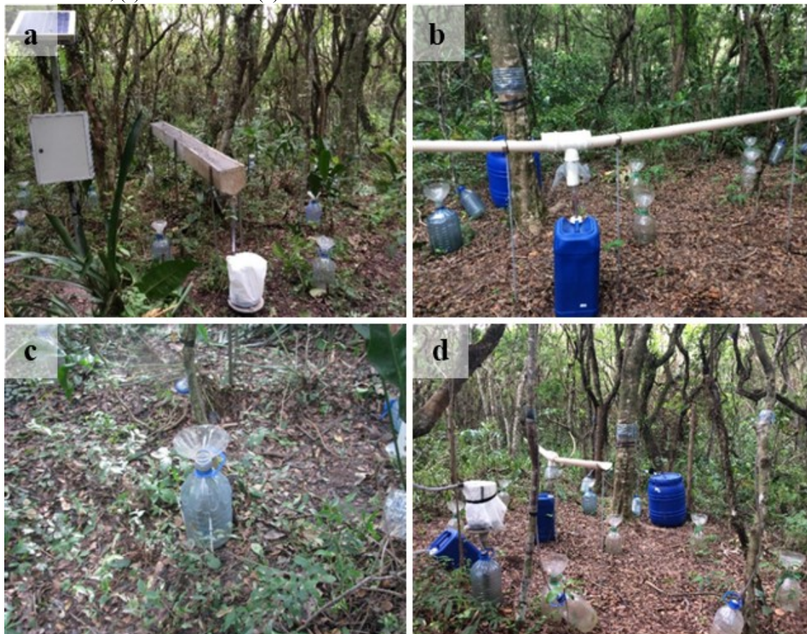
Figura 3-6 Monitoramento da chuva interna da Parcela Peri 1: (a) Calha ligada ao pluviógrafo; (b) Calha ligada ao galão de 30 litros; (c) Pluviômetro e (d) Pluviômetros distribuídos na Parcela.
