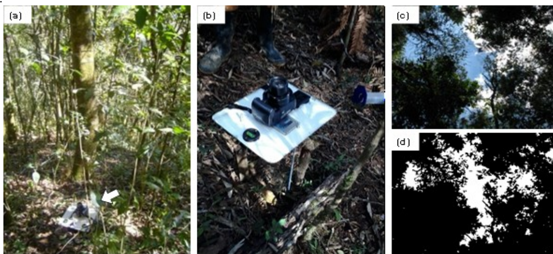
Figura 3-15 Fotografia do dossel. (a) Instalação da câmera na plataforma entre a vegetação. (b) Detalhe da câmera na plataforma nivelada. (c) Exemplos da foto do dossel. (d) Imagem binária correspondente a foto do dossel em (c).
