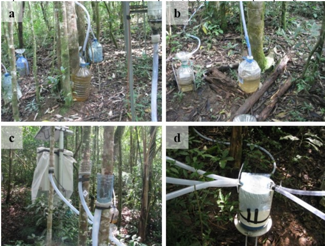
Figura 3-9 Monitoramento do escoamento pelo tronco na Bacia Araçá: (a) recipiente de armazenamento cheio; (b) recipiente de armazenamento; (c) coletor do tipo espiral; e (d) ligação das árvores para o pluviógrafo.
