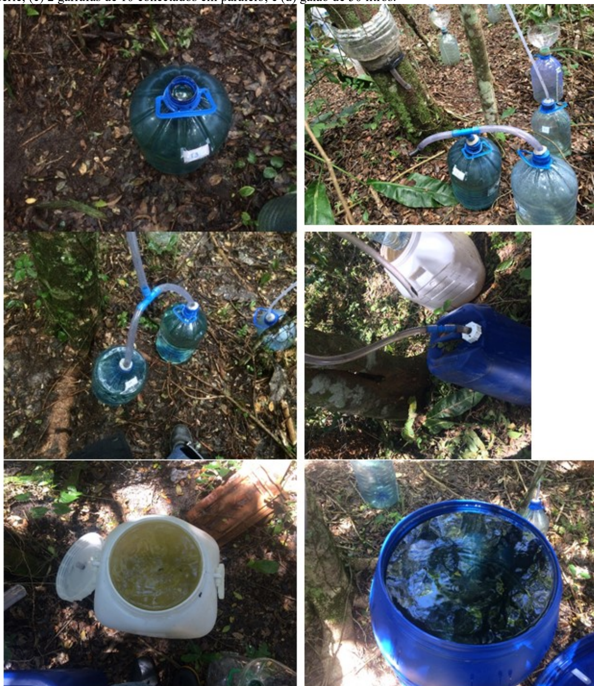
Figura F-16 Armazenamento do escoamento pelo tronco; (a) 10 litros; (b) 2 garrafas de 10 litros conectados em série; (c) 2 garrafas de 10 conectados em paralelo; e (d) galão de 50 litros.
