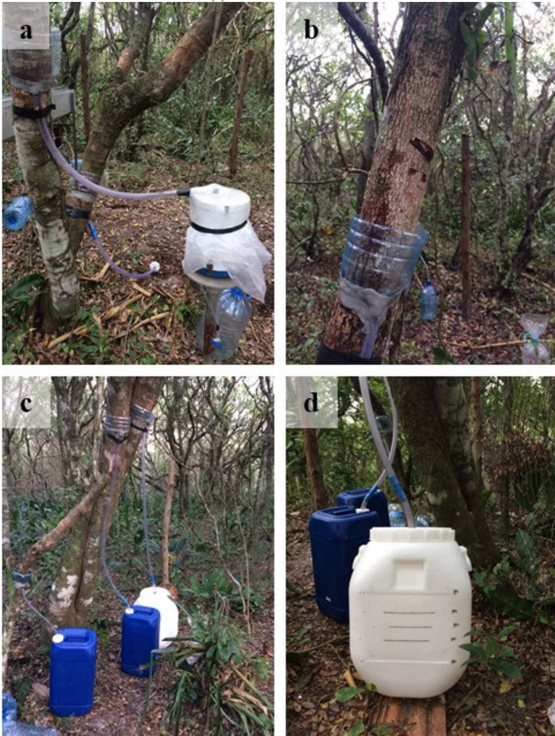
Figura 3-10 Escoamento pelo tronco. (a) Coletor ligado ao pluviógrafo; (b) Coletor do escoamento pelo tronco; (c) Armazenamento dos troncos menores e (d) Armazenamento dos troncos com maior volume.
