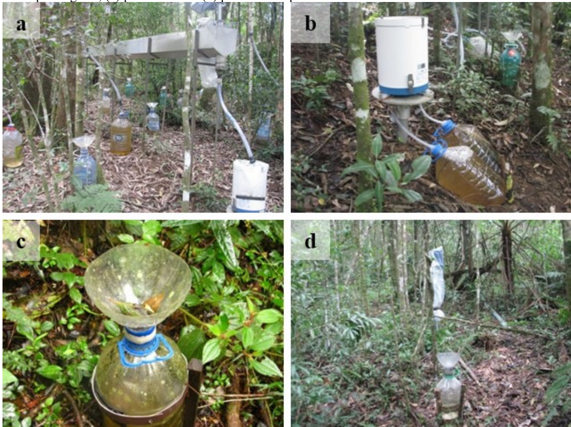
Figura 3-4 Monitoramento da chuva interna na bacia da Araponga: (a) calha ligada ao pluviógrafo; (b) garrafas ligada ao pluviógrafo; (c) pluviômetro e (d) pluviômetro próximo do tensiômetro.
