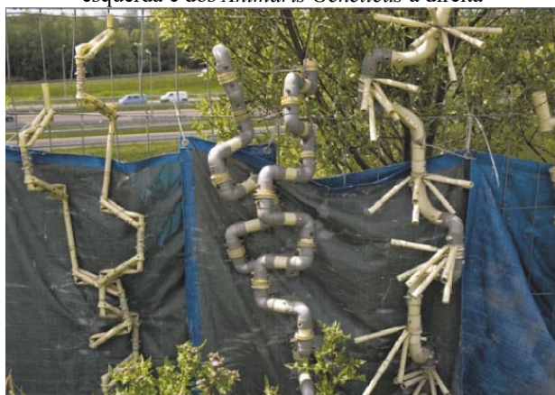
Figura 20 – Virabrequins (“colunas vertebrais”) dos Animaris Currens à esquerda e dos Animaris Geneticus à direita
