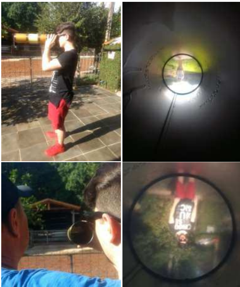
Figura 38. Observação da imagem invertida através da câmara escura.
