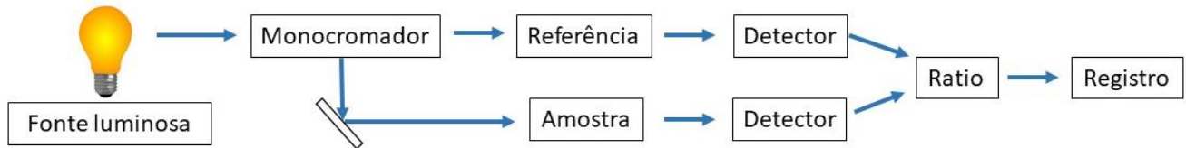
Figura 6 - Princípio de medição: Percurso do feixe de luz no canal de referência e na amostra da sonda ótica, comparação no Processador e resultado.
