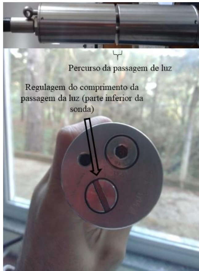
Figura 7 - Regulagem do comprimento do percurso da luz de medição, específico para cada tipo de efluente que pretende-se monitorar.
