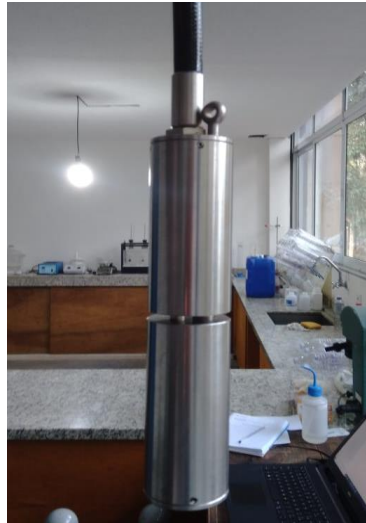
Figura 5 - Analisador UV/VIS– Sensor Ótico para medição in situ e controlador
