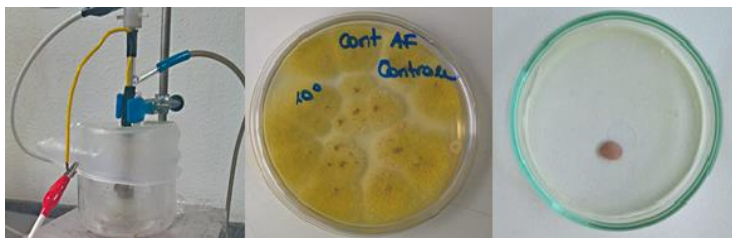
Figura 1. (a) Reator de plasma a frio (PF) tipo jato de plasma com descarga em barreira dielétrica; (b) colônia fúngica ( Aspergillus flavus ) controle e (c) mesma colônia fúngica após 8 dias de tratamento por PF.
