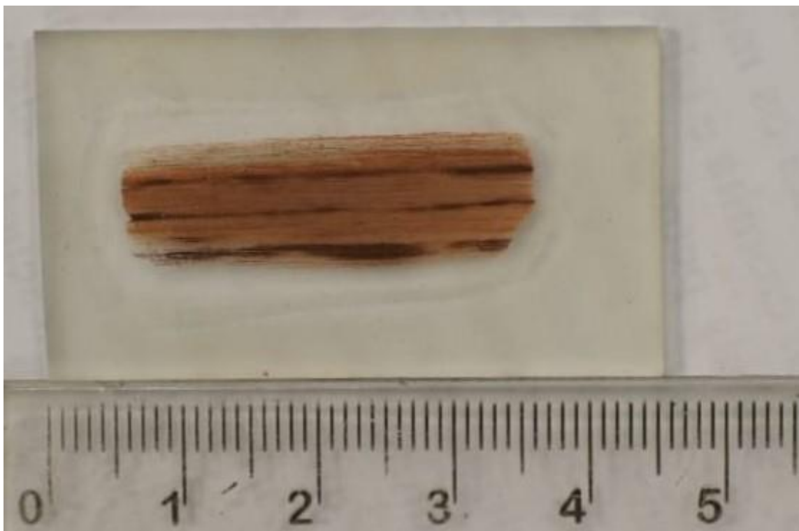
Figura 31: Seção delgada produzida a partir da amostra coletada no talude.
