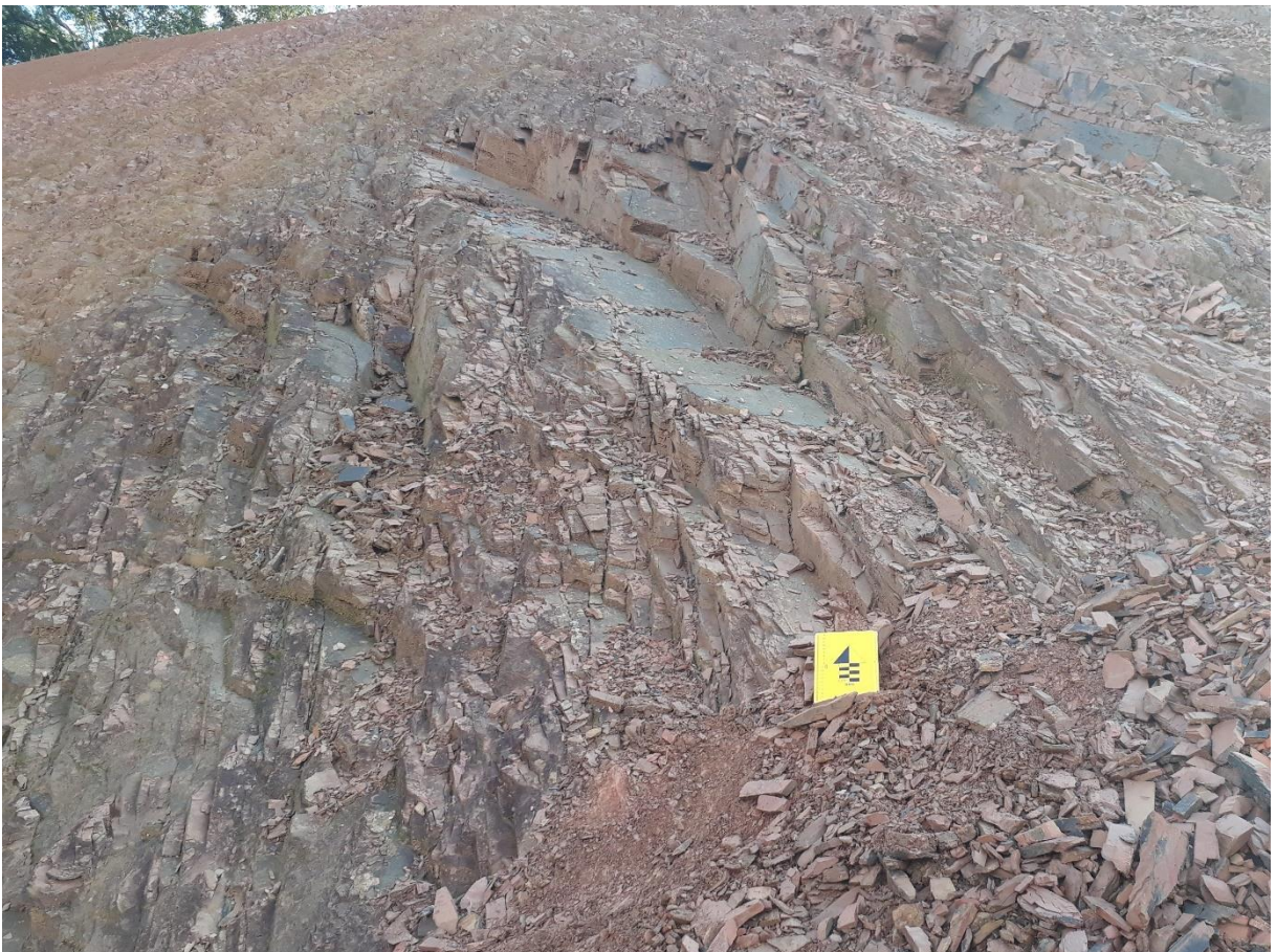
Figura 40: Detalhe de pequenas rupturas em cunha. Caderneta de escala.
