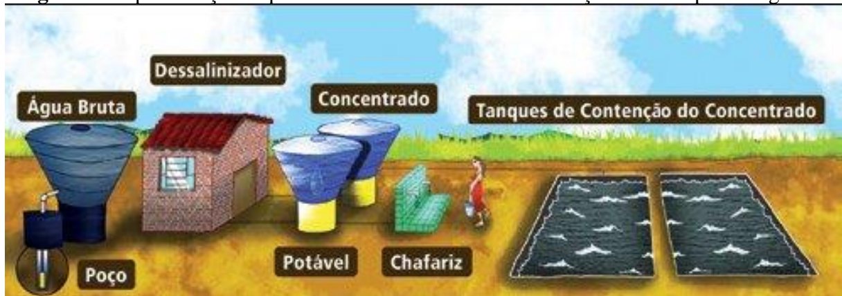
Figura 3: Representação esquemática do sistema de dessalinização adotado pelo Programa.
