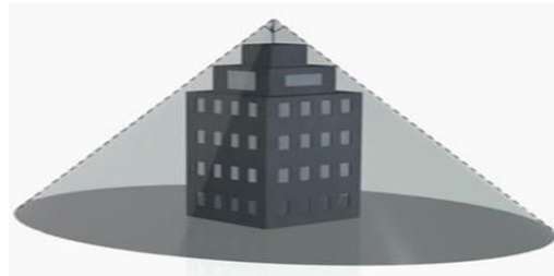
Figura 13 – Cone correspondente ao Método do Ângulo de Proteção.
