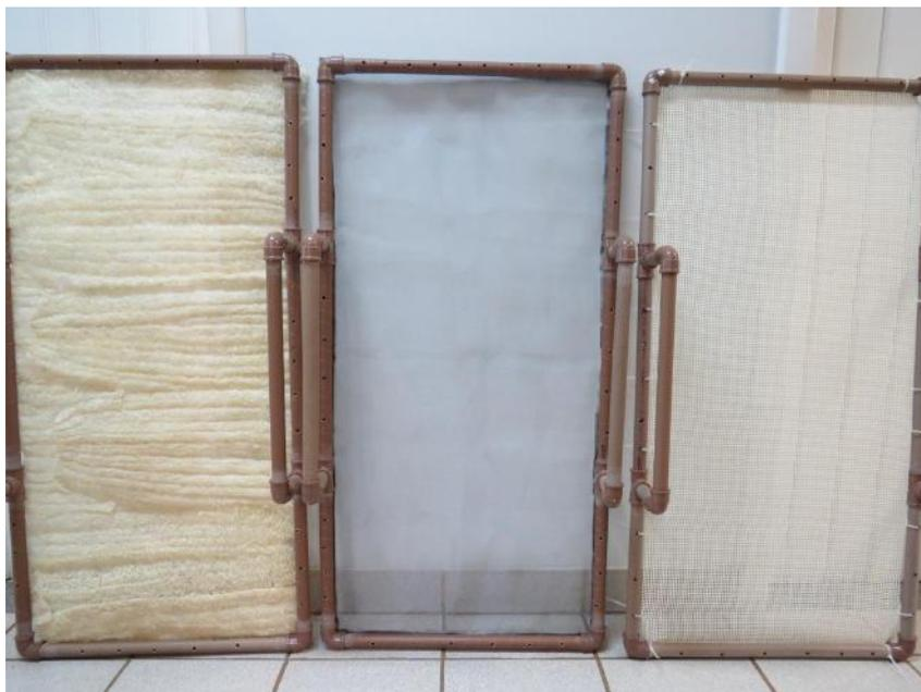
Figura 5 – *Algal Traps* montados com diferentes malhas para teste de colonização de substratos: *Luffa cylindrica*, malha de nylon, e malha de nylon com PVC expandido, respectivamente da esquerda para a direita. Foto da autora.
