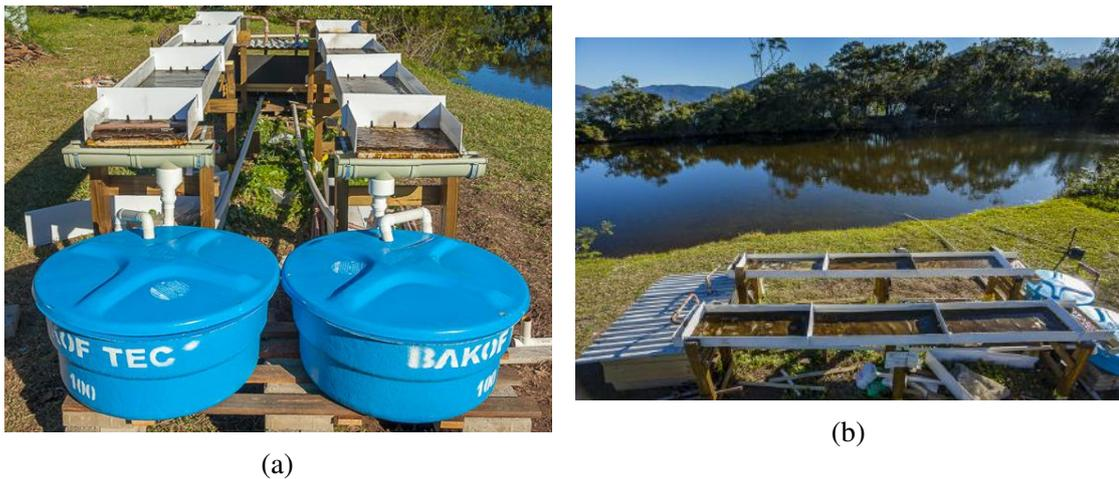
Figura 12 – *Algal Turf Scrubber* construído e funcionando baseado no Regime Fechado de circulação de água. Fotos de Eduardo Bastos.
