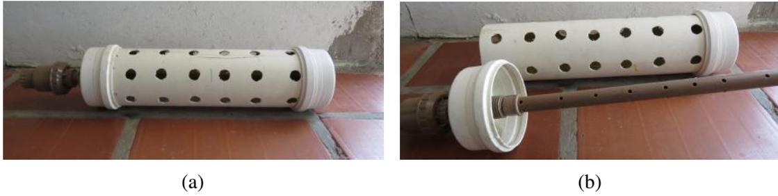
Figura 11 – Ponteira para captação de água construída e utilizada para o ATS em Regime Aberto de circulação de água. Em (a) ponteira montada sem filtro e em (b), ponteira desmontada, mostrando a segunda passagem de água. Fotos da autora.
