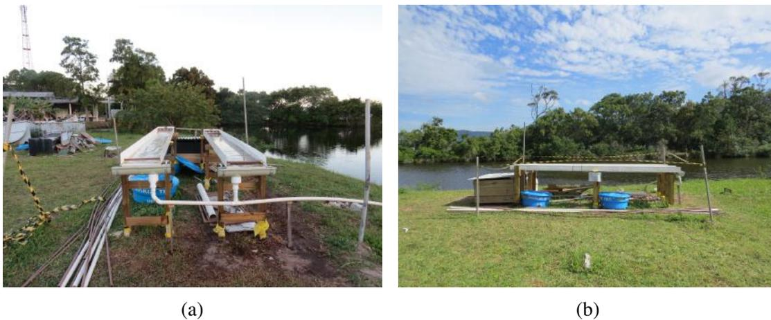
Figura 10 – *Algal Turf Scrubber* construído e funcionando baseado no Regime Aberto de circulação de água. Em (a), vista frontal do sistema e em (b), vista lateral. Fotos da autora.
