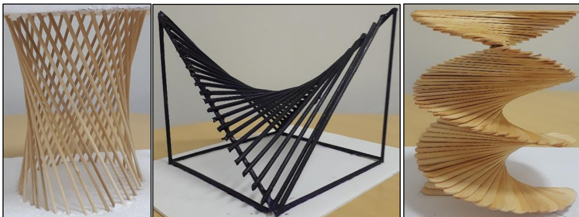
Figura 02 – Maquetes das superfícies regradadas (hiperbolóide de uma folha, parabolóide hiperbólico e helicóide).
