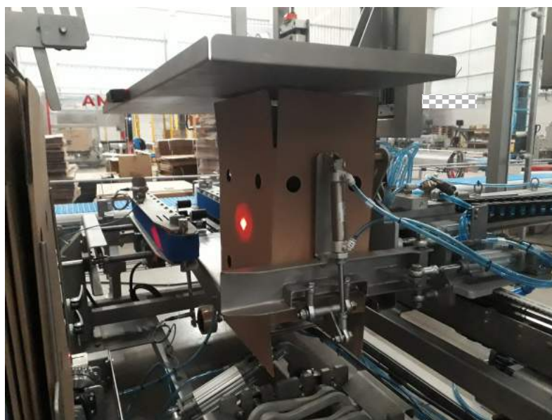
Figura 72 – Caixa esquadrejada na formadora.
