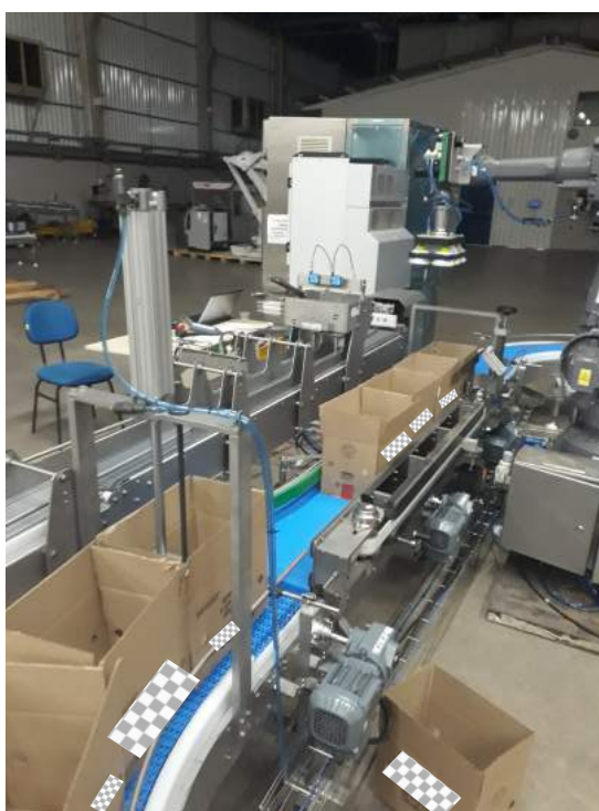
Figura 76 – Caixas na esteira de encaixotamento.
