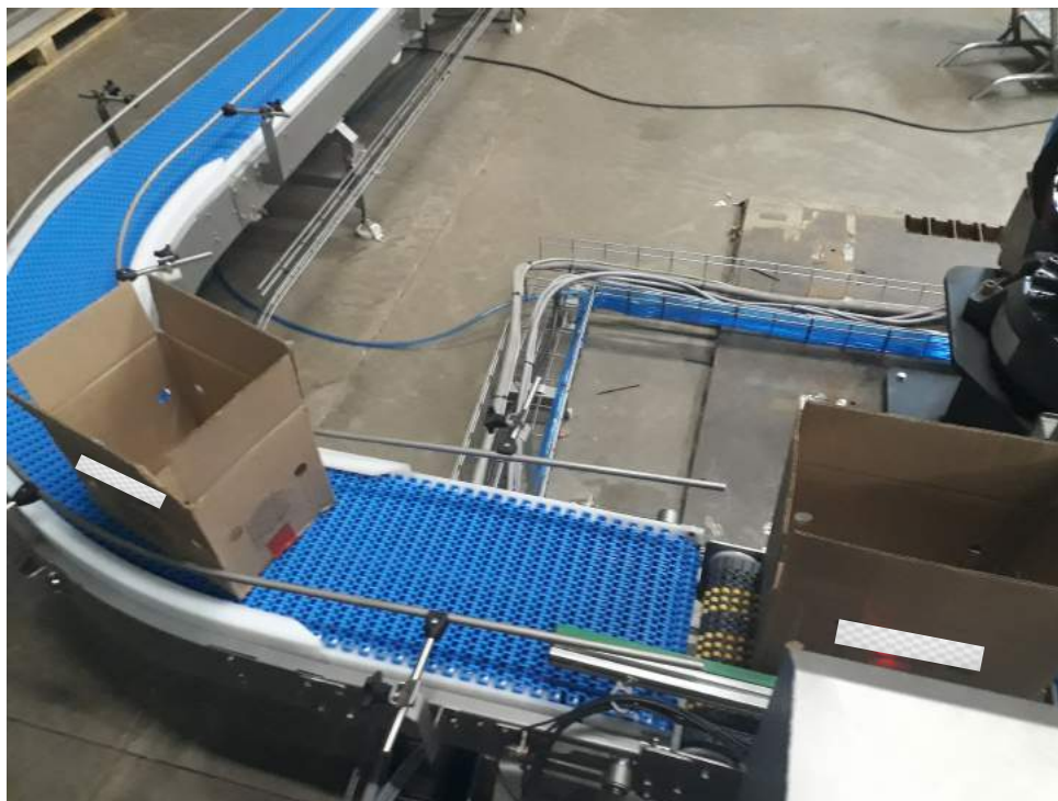
Figura 81 – Saída das caixas na encaixotadora.
