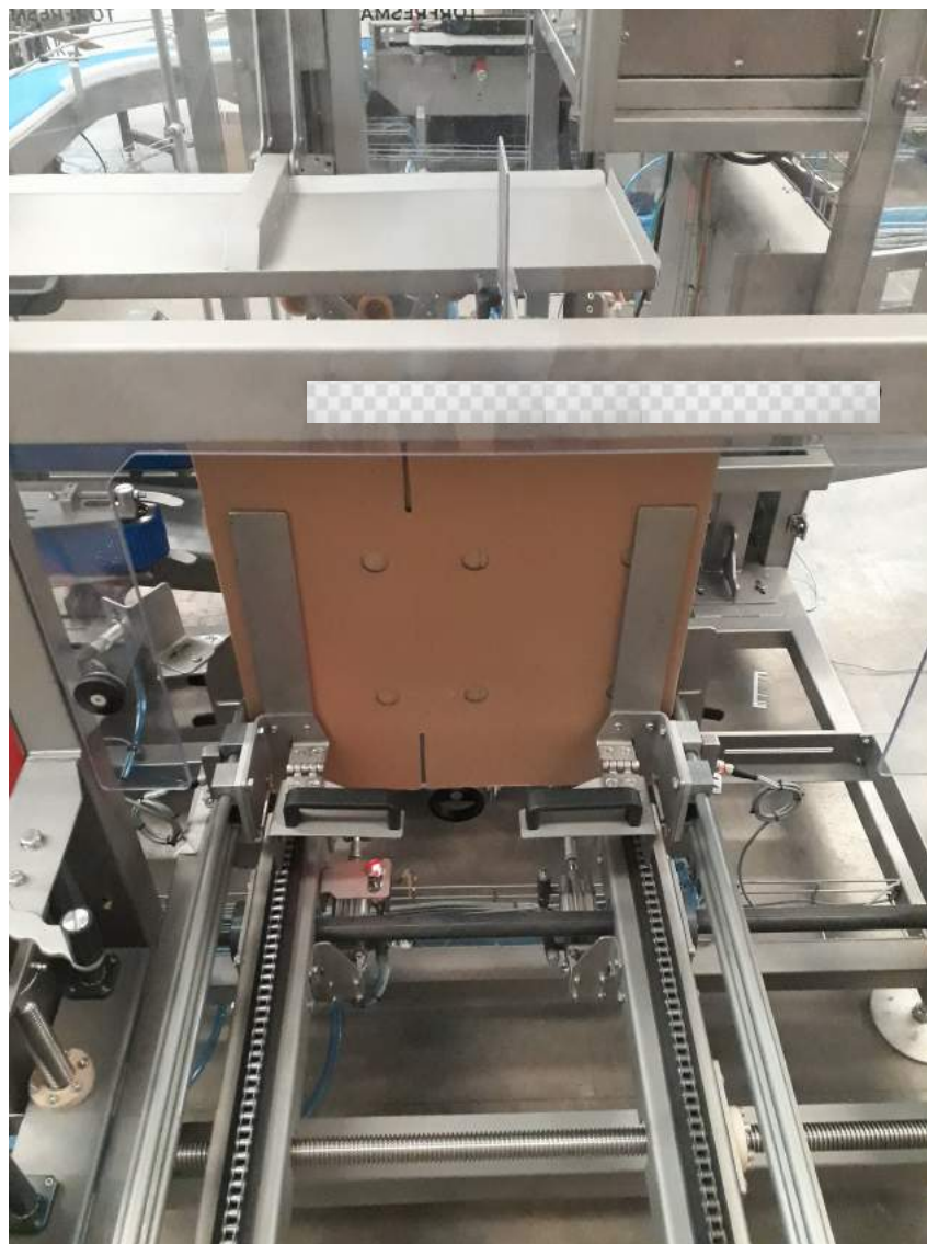
Figura 70 – Estoque de caixas da formadora.
