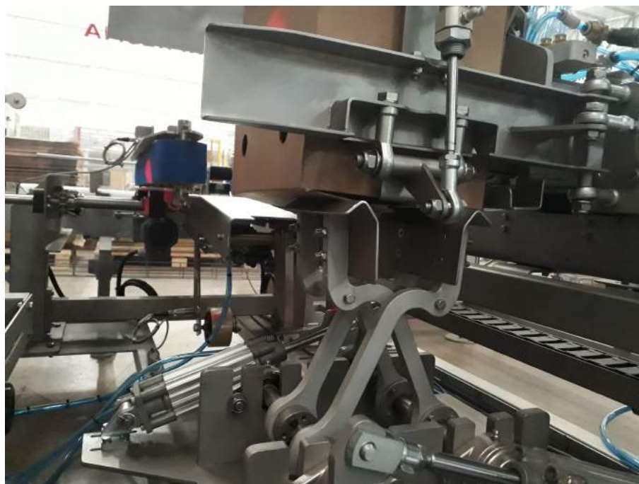
Figura 73 – Abas dobradas da caixa na formadora.
