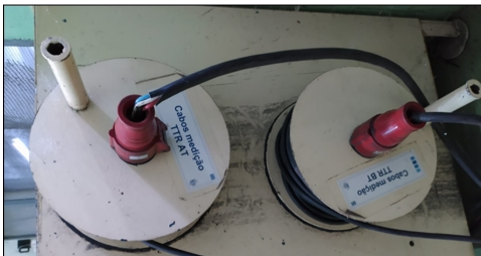
Figura 48 – Rolos de cabo para o ensaio de relação de transformação feito a partir do TTR 2795.
