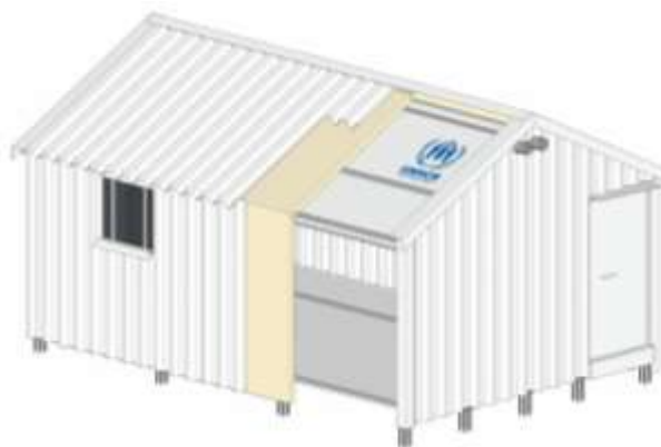
Figura 2 : Diagrama do projeto de abrigo no campo de refugiados Azraq. Fonte: UNHCR, 2016.
