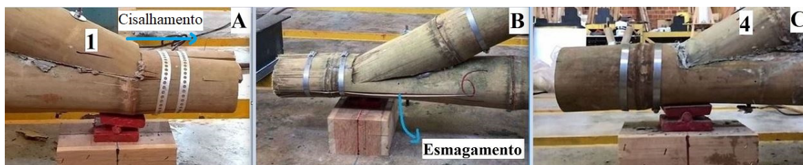
Figura 9:Três situações distintas capturadas na iminência da ruptura. Fonte autores.
