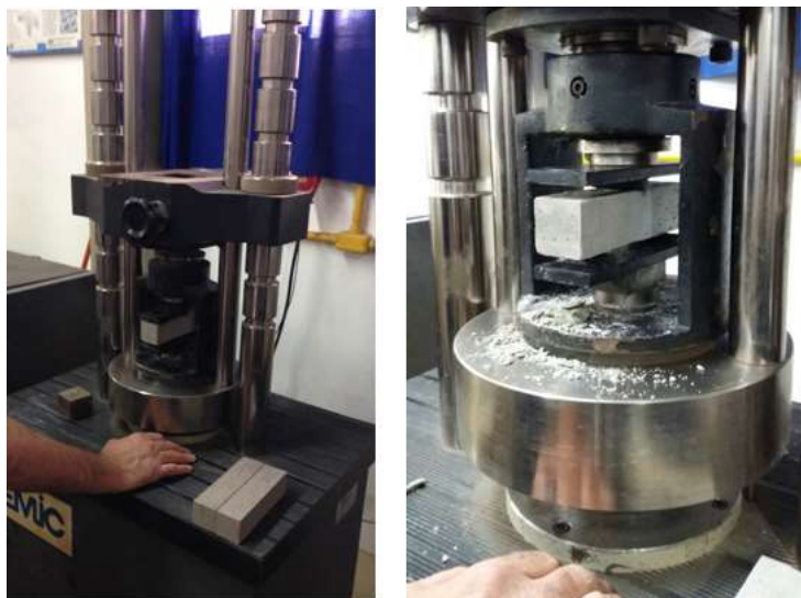
Figura 6: Rompimento dos corpos de prova (Ensaio de tração na flexão). Fonte: Elaborado pelos autores
