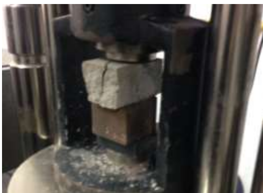
Figura 7: Rompimento dos corpos de prova prismáticos (Ensaio de compressão). Fonte: Elaborado pelos autores
