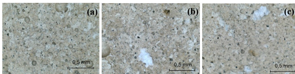
Figura 02 - Aspecto da superfície fraturada do corpo de prova da amostra Rcom sem EVA (a); Rcom contendo o 1º teor de EVA (b); Rcom contendo o 2º teor de EVA (c). Fonte: elaborado pelos autores.
