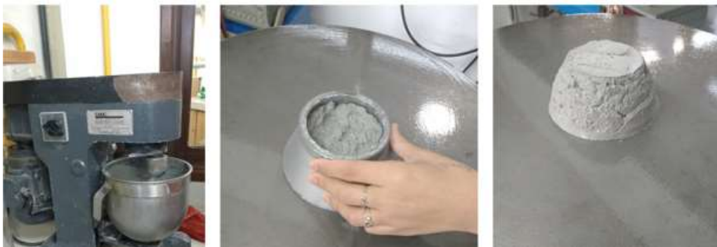
Figura 3: Argamassa preparada no misturador mecânico e adicionada ao molde tronco cônico. Fonte: Elaborado pelos autores
