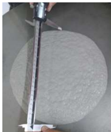
Figura 4: Argamassa na mesa de espalhamento. Fonte: Elaborado pelos autores
