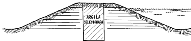
Seção transversal da barragem
