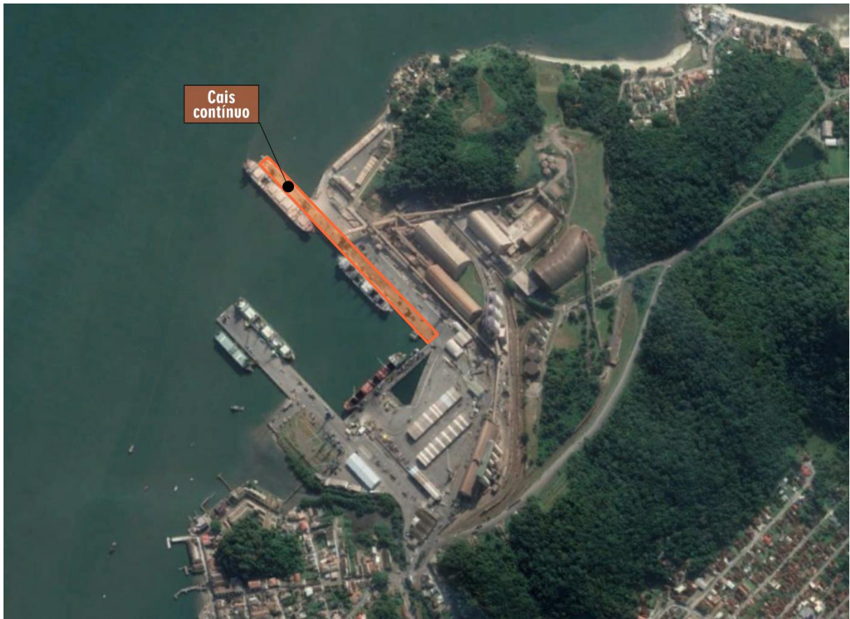
Figura 3 - Exemplo de cais contínuo
