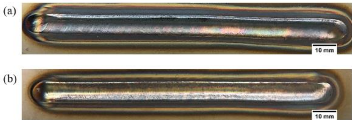
Figura 30 – Aspecto superficial para 7A de corrente na bobina, 100A de corrente de soldagem e campo magnético externo: (a) No sentido NORTE; (b) No sentido SUL.
