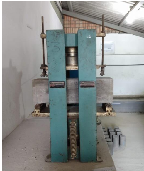
Figura 17 - Corpo de prova posicionado na prensa hidráulica
