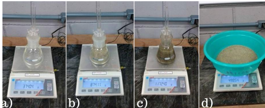
Figura 13 - Pesagem do frasco (a); Pesagem do conjunto (b); Pesagem do conjunto mais água (c); Passagem da amostra após estufa (d)
