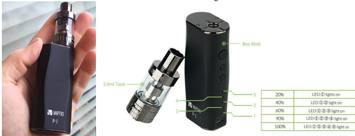
Figura 6: Exemplo de cigarro eletrônico de 3ª geração do tipo mod regulado, que neste modelo inclui o com controle de voltagem.
