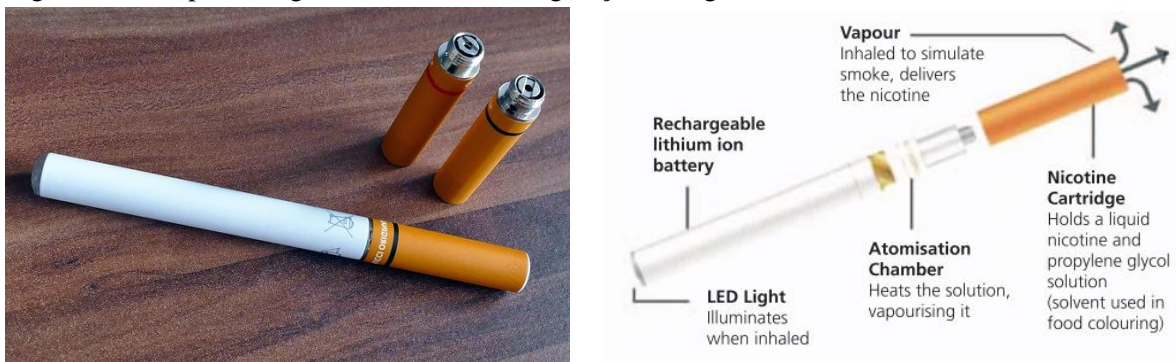
Figura 2: Exemplo de cigarro eletrônico de 1ª geração e diagrama demonstrando o seu funcionamento.
