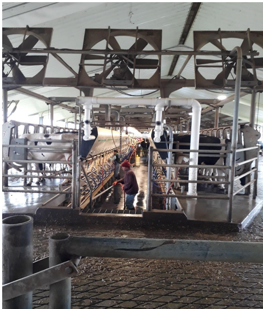
Figura 9- Fosso para ordenha com conjuntos de teteiras em ambos os lados.
