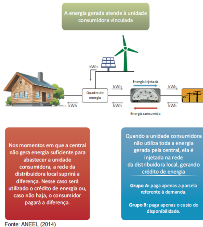
Figura 7 – Sistema de compensação de energia. Fonte: [3]
