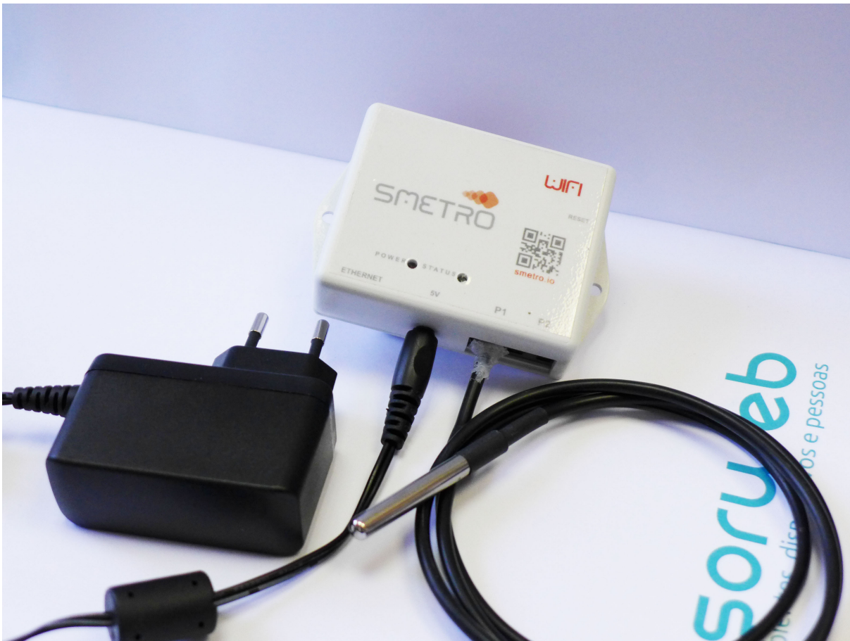
Figura 6 – Dispositivo Smetro WiFi.
