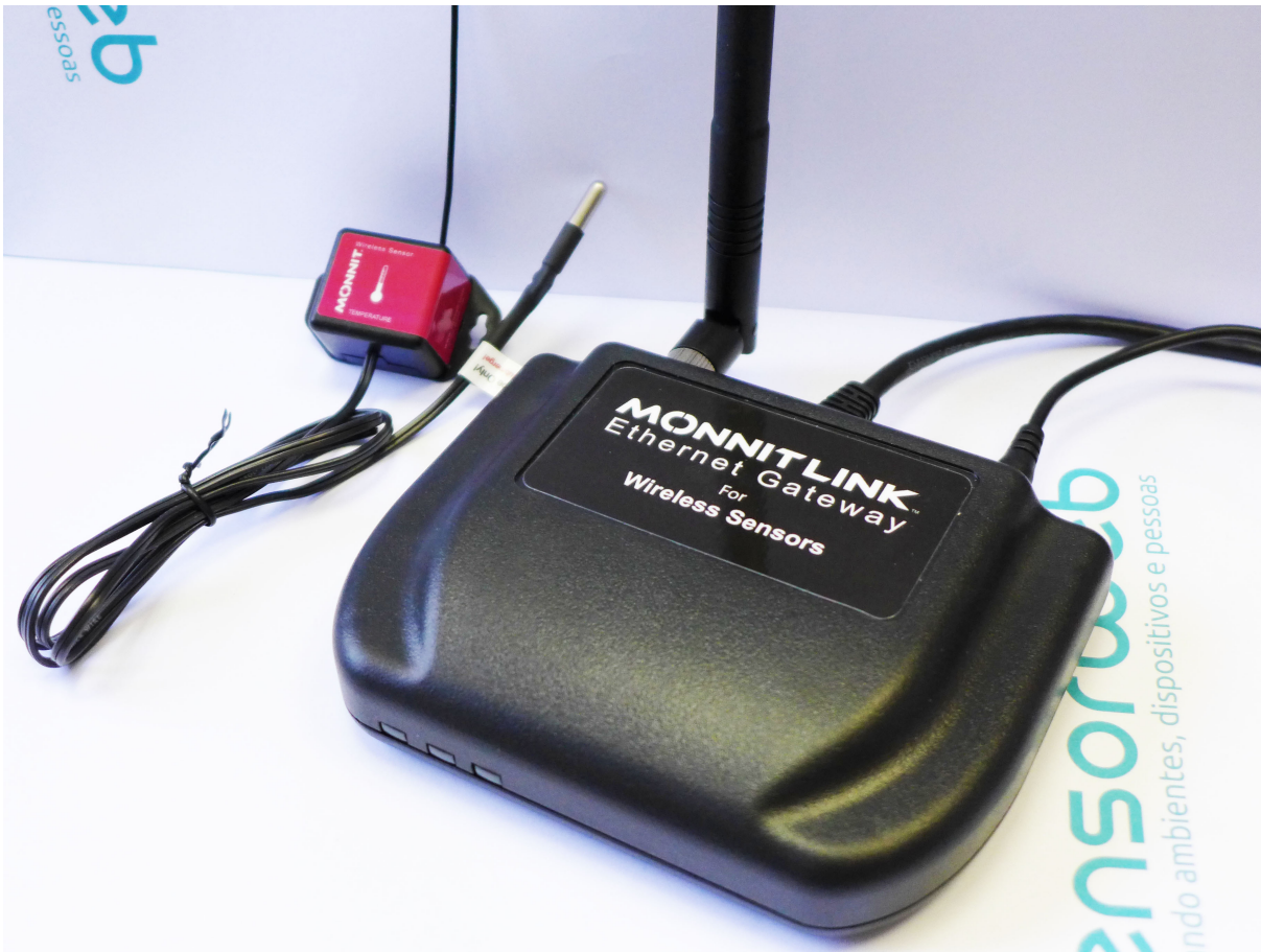
Figura 8 – Dispositivo Monnit e Gateway.
