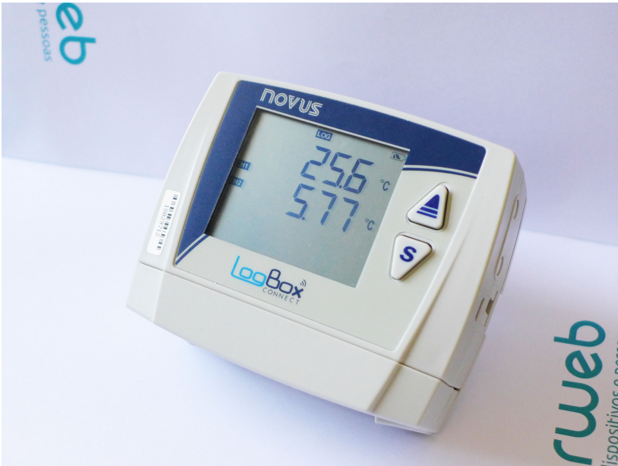
Figura 7 – Dispositivo Novus Logbox.
