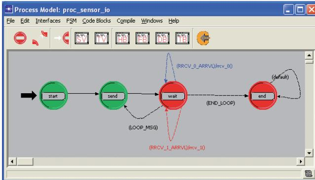
Figura 5.23: Modelo de processo do nó sensor E/S.
