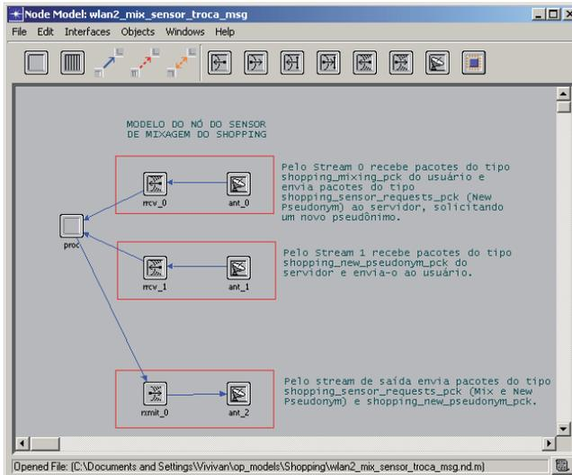
Figura 5.38: Modelo de nó do sensor de mixagem.
