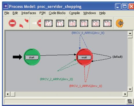
Figura 5.34: Modelo de processo do nó servidor.
