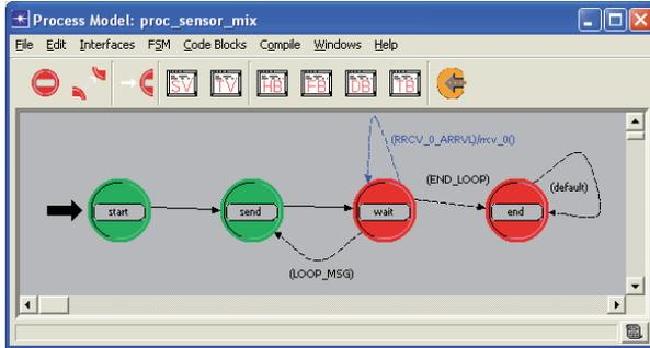
Figura 5.39: Modelo de processo do sensor de mixagem.
